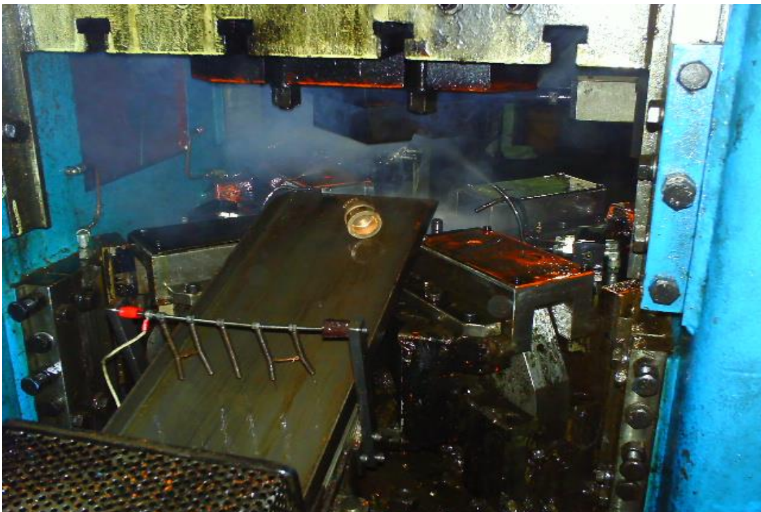
Σχήμα 12-17: Σφυρηλάτηση σε πρέσα
