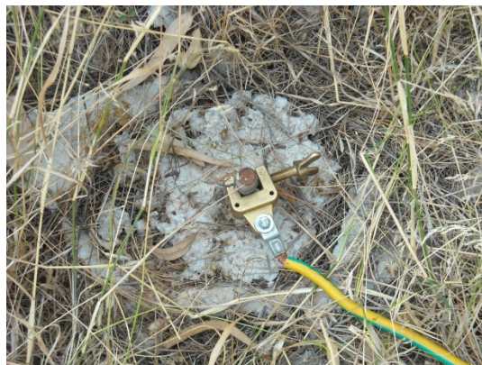
Εικόνα 3.14: Κατακόρυφη ράβδος εντός βελτιωτικού υλικού υπό κρουστική καταπόνηση.
