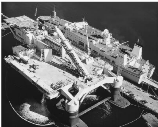
Εικόνα 2.52 Όχημα θαλάσσιων εκτοξεύσεων Sea Launch, με την πλατφόρμα εκτόξευσης Odyssey και το πλοίο ελέγχου [2]
