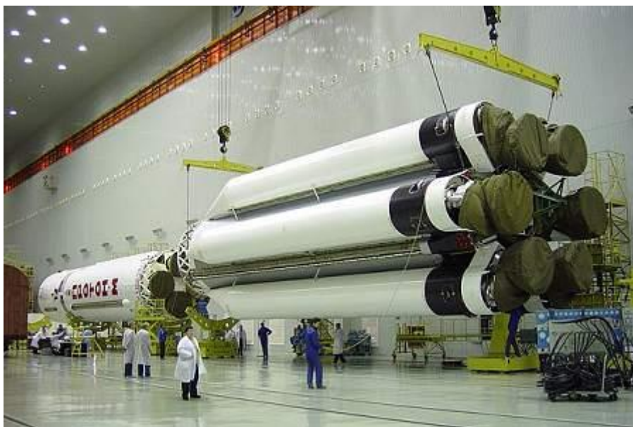
Εικόνα 2.44 Η συναρμολόγηση των μηχανών πρώτου και δεύτερου σταδίου στο Baikonur[47]
