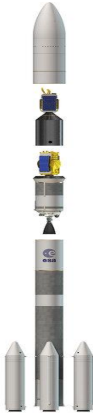
Εικόνα 2.3 Σχεδιασμός του οχήματος εκτόξευσης Ariane 6 [29]
