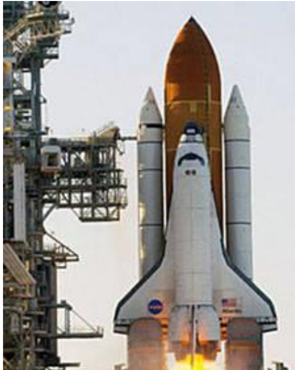
Εικόνα 2.8 Το Διαστημικό λεωφορείο αποτελείται από το τροχιακό όχημα, την εξωτερική δεξαμενή καυσίμων και τους προωθητήρες [36]
