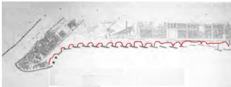
Σχ. 1.2 Πρακτική έξαλων αποσπασμένων κυματοθραυστών τη δεκαετία του 70 και δημιουργία tombolo (σημαινόμενα με κόκκινη γραμμή) στην Όστια, Δυτική Ιταλία.
