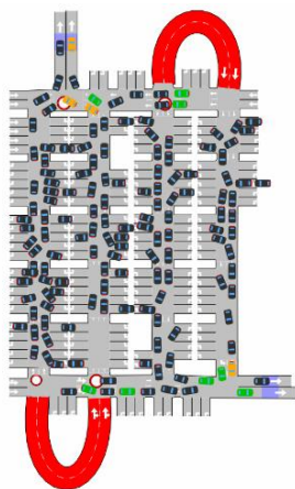
Σχήμα 3.8: Εκκένωση κατά στάδια (Κλείσιμο ραμπών ανόδου)
