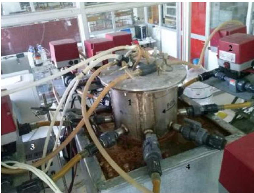
Εικόνα 7.1 Πειραματική διάταξη του αντιδραστήρα PABR (1). Στην άνωθι εικόνα διακρίνονται οι ηλεκτρονικές βάνες, (2) η συνδεσμολογία τους, (3) θερμοστάτης και το υδατόλουτρο (4) που περιβάλλει τον αντιδραστήρα
