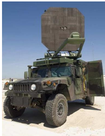
Εικόνα 4 : Ενεργό σύστημα άρνησης (ADS)
