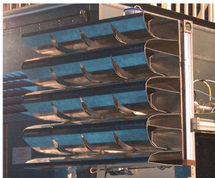
Εικόνα 56: Η βελτιστοποιημένη συστοιχία 16 K κεραιών σε επαφή
