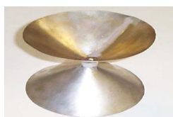
Εικόνα 37: Η τυπική δομή μιας Biconical κεραιάς
