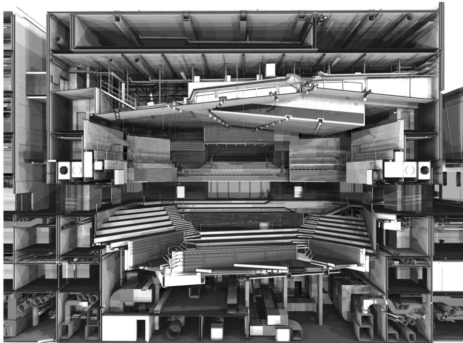
Σχήμα 2.19: Τομή του μοντέλου BIM στο περιβάλλον του λογισμικού MagiCAD για εντοπισμό συγκρούσεων (Εαστμαν et al., 2008)
