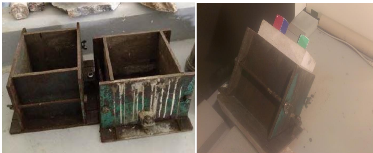
Εικόνα 17: Μεταλλικό καλούπι και η επιφάνεια πρόσκρουσης.
