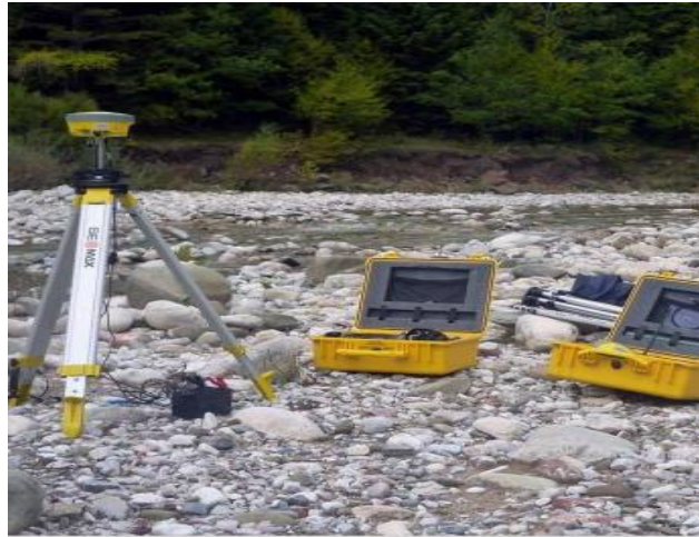
Εικόνα 5.1-1: Εξοπλισμός αποτύπωσης τοπογραφίας ( www.ecoflow.gr )
