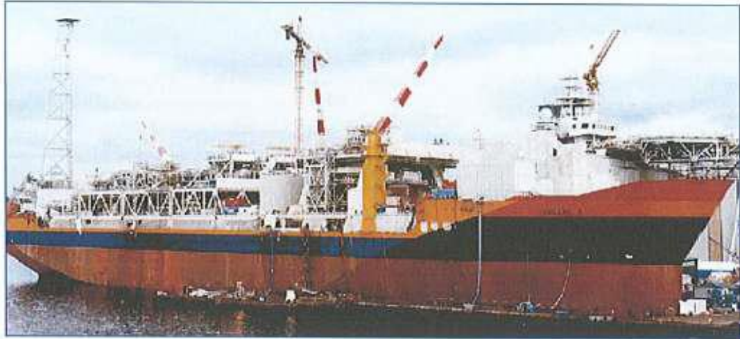
Εικόνα 1-5: FPSO με τα topsides στο κύριο κατάστρωμα και τον χώρο του accommodation στο πωραίο τμήμα (Ravi K., “FPSO Design – an Introduction”)
