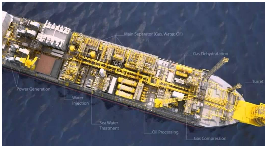
Εικόνα 1-6: Κάτοψη των μονάδων επεξεργασίας και παραγωγής ενέργειας στο κύριο κατάστρωμα ενός FPSO ( www.sbmoftshore.com )
