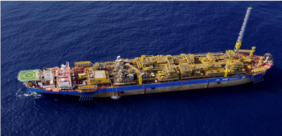
Εικόνα 1-4: FPSO με τα topsides στο κύριο κατάστρωμα και τον χώρο του accommodation στο πρυμναίο τμήμα ( www.sbmoffshore.com )
