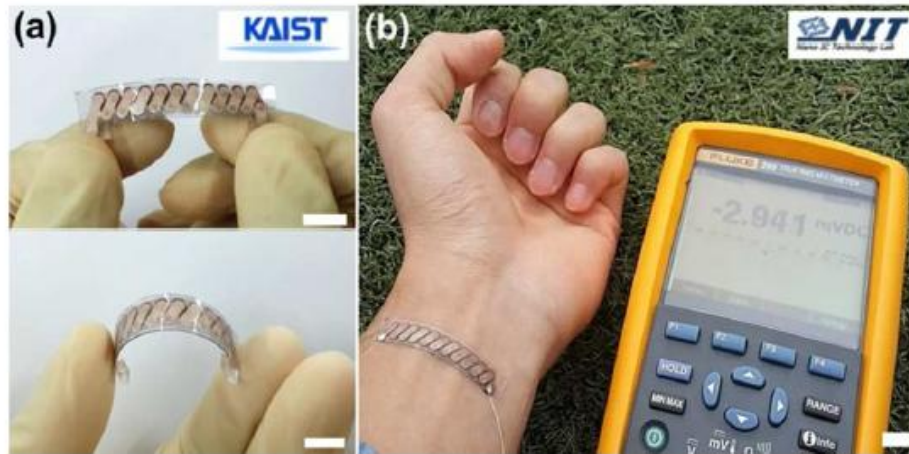
Εικόνα 3.12: Θερμοηλεκτρικός μετατροπέας σε μορφή επιδέσμου για συγκομιδή θερμικής ενέργειας από το ανθρώπινο δέρμα (γραμμική κλίμακας 1cm) [Kim et al., 2014]
