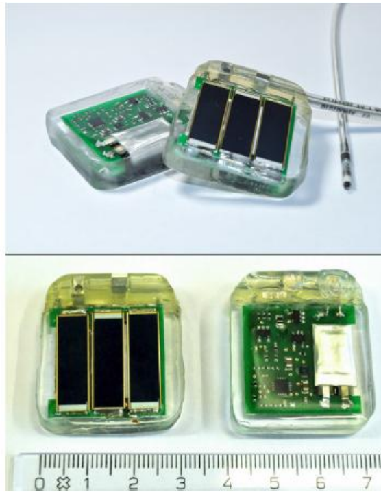
Εικόνα 3.2: Πρωτότυπο βηματοδότη που τροφοδοτείται από ηλιακή ακτινοβολία [Haeberlin et al., 2015]
