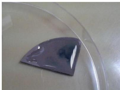
*Σχήμα 5.3: Δείγμα πυριτίου με επικάλυψη APTES. Στο σημείο που υπάρχει το πράσινο σκούρο χρώμα είχε τοποθετηθεί διάλυμα με βιοτίνη, και το σήμα αυτό επιβεβαιώνει την παρουσία APTES στην επιφάνεια του πυριτίου.*
