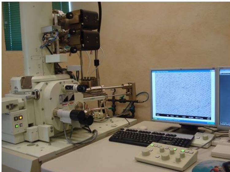
*Σχήμα 2.4: Η Διάταξη SEM του εργαστηρίου μικροηλεκτρονικής*
