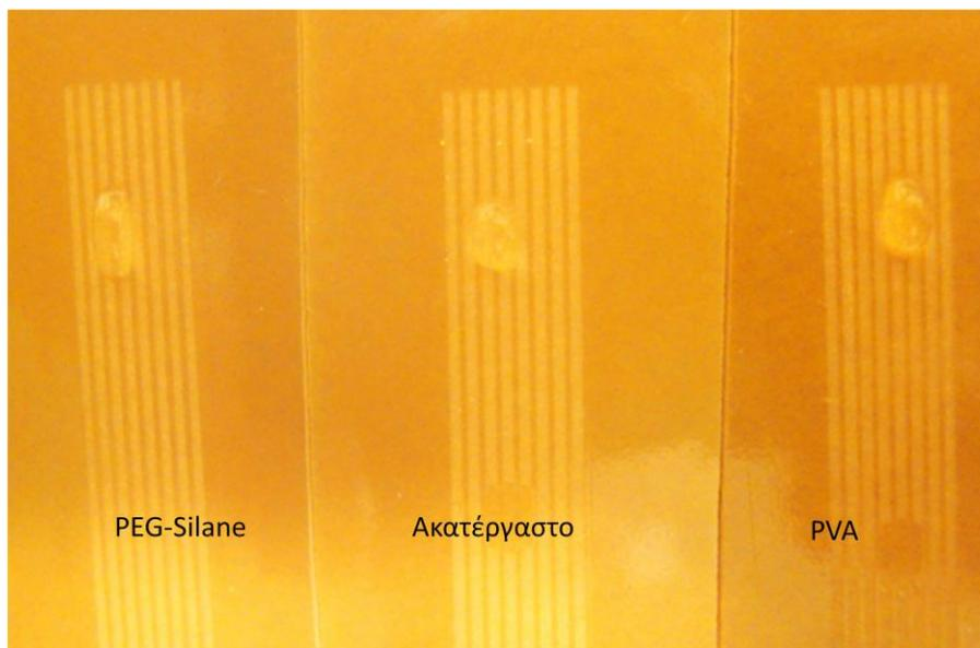
Σχήμα 6.3: Φωτογραφίες σταγόνων νερού, 5  $\mu\text{l}$ , σε κανάλια FR4, με επικάλυψη PEG-Silane (αριστερά), ακατέργαστα (στη μέση), και με επικάλυψη PVA(δεξιά)
