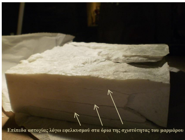
Εικόνα 74 - Αστοχία του δοκιμίου στα όρια της σχιστότητας 4
