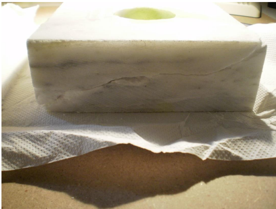
Εικόνα 102 - Αστοχία στα όρια της σχιστότητας του δοκιμίου
