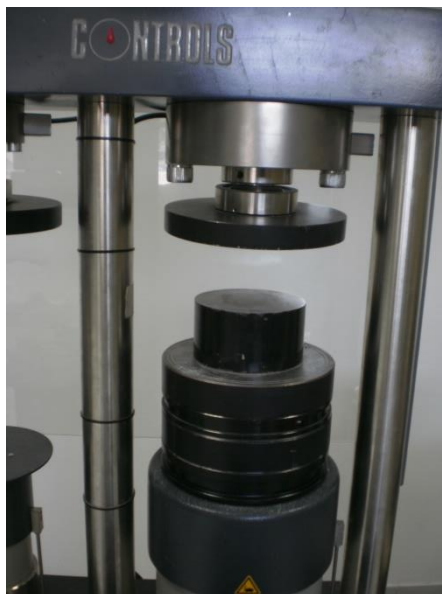
Εικόνα 24 - Πλαίσιο μονοαξονικής θλίψης με έμβολο δυναμικότητας 250 kN
