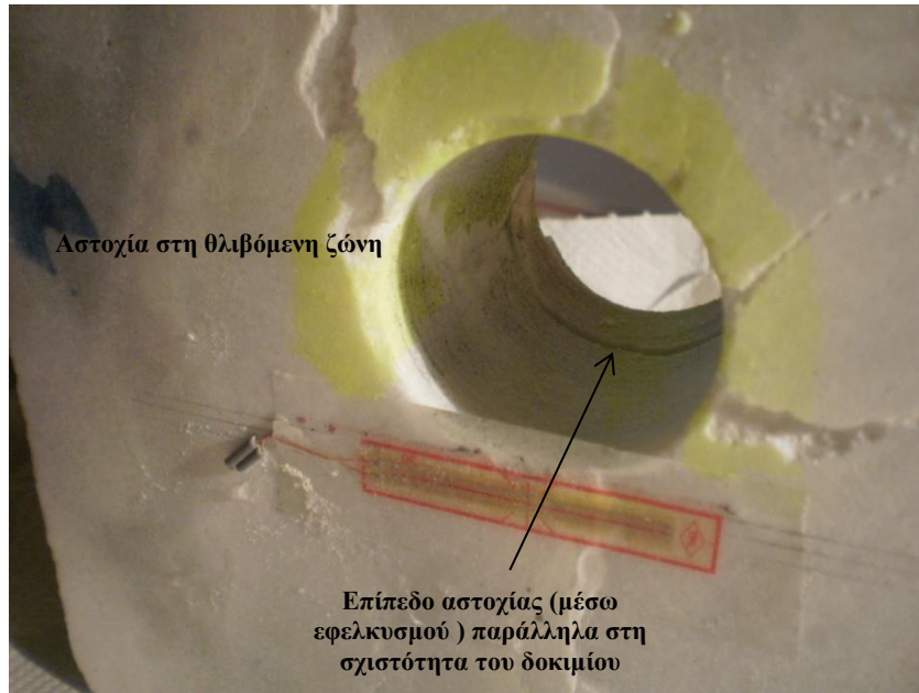
Εικόνα 98 – Αστοχία παράλληλα στη σχιστότητα του δοκιμίου
