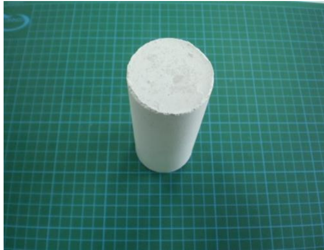
Εικόνα 30 - Κυλινδρικό γύψινο δοκίμιο διαστάσεων 12 x 5,5 cm
