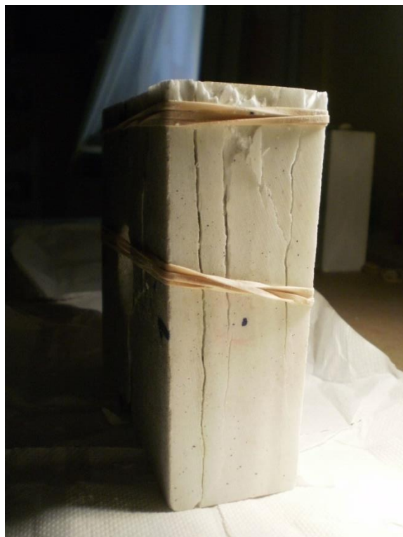
Εικόνα 87 - Χαρακτηριστική αποκόλληση της σχιστότητας του μαρμάρου μέσω εφελκυσμού
