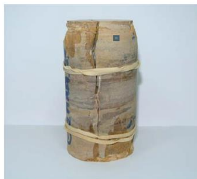
Εικόνα 2 - Μακροσκοπική θραύση δοκιμίου πετρώματος σε δοκιμή μονοαξονικής θλίψης. Η θραύση αναπτύχθηκε παράλληλα προς την αξονική θλιπτική τάση (Πηγή: Νομικός, 2016)
