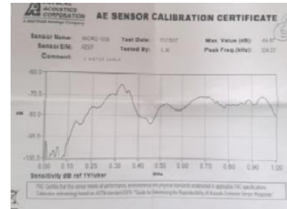
Εικόνα 21 - Πιστοποιητικό βαθμονόμησης αισθητήρων micro 100S .PAC (Πηγή: Εργαστήριο Τεχνολογίας Διάνοιξης Σηράγγων)
