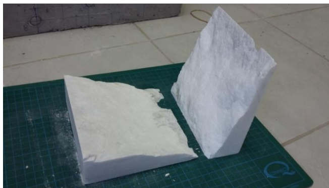
Εικόνα 105 - Αστοχία της πλάκας (χωρίς σπή) σε διάτμηση
