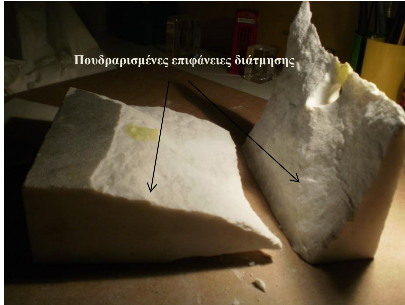
Εικόνα 72 - Διατμητική θραύση του δοκιμίου
