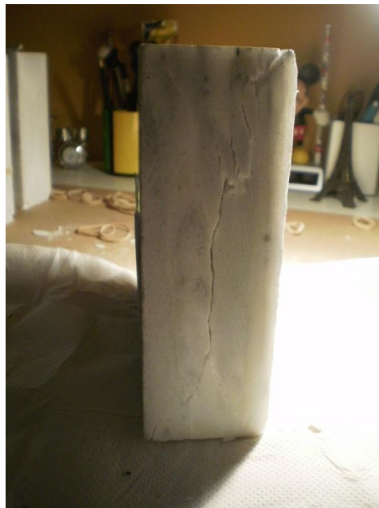
Εικόνα 97 - Ρωγμάτωση παράλληλα στη σχιστότητα του δοκιμίου
