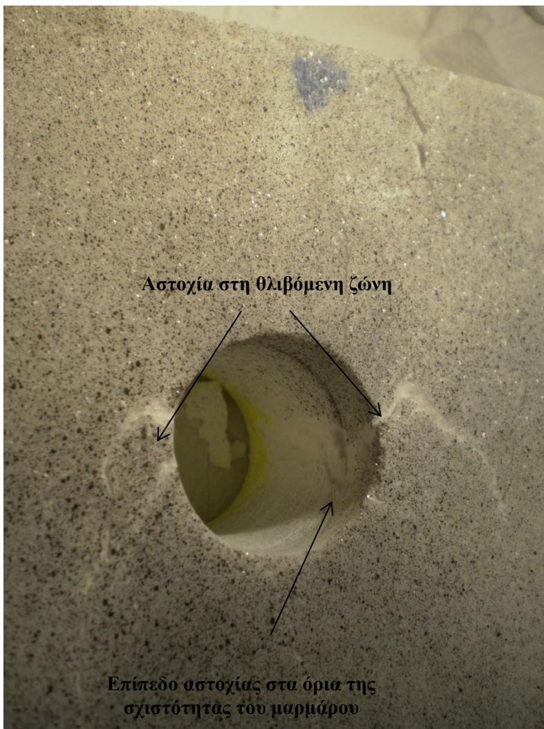
Εικόνα 95 - Αστοχία στη θλιβόμενη ζώνη
