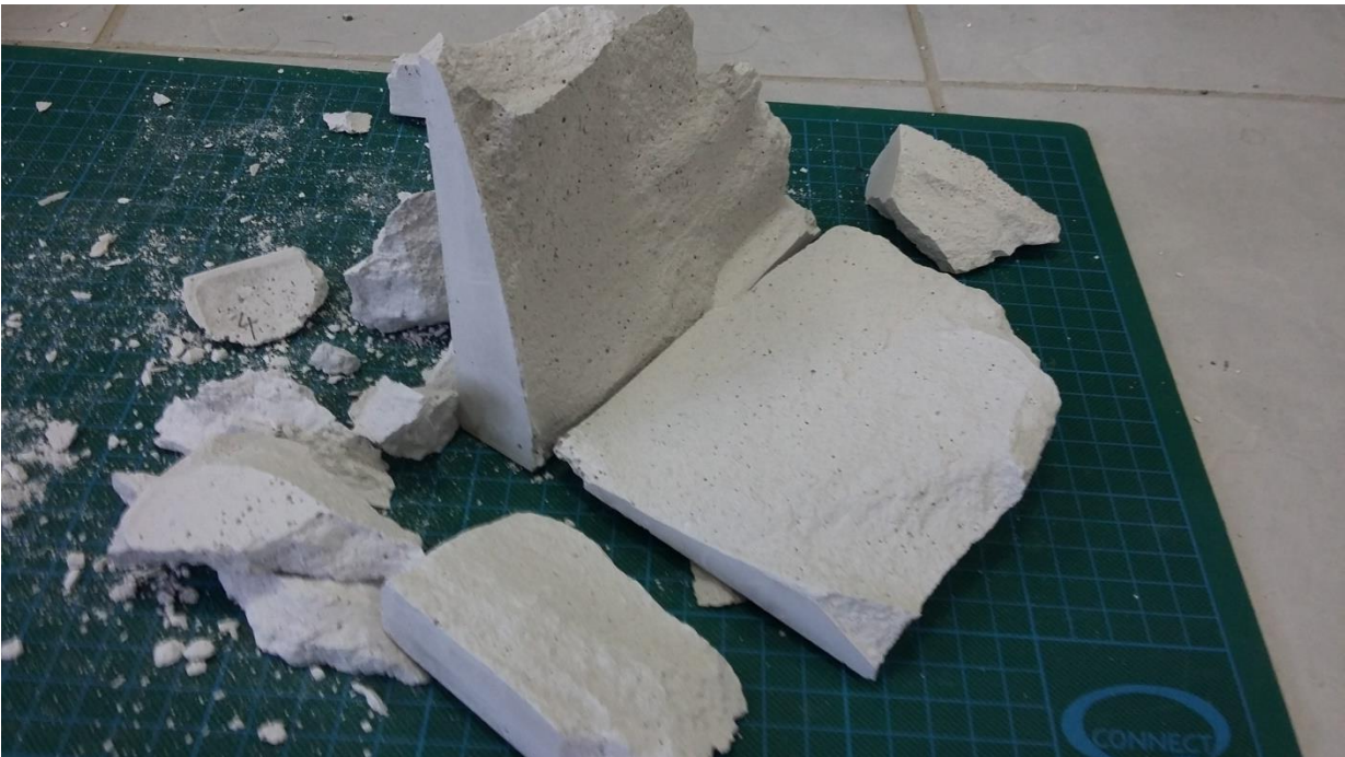
Εικόνα 67 - Θραύση της 2 ης πλάκας χωρίς σπή υπό διάτμηση
