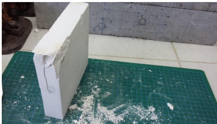
Εικόνα 68 - Θραύση της 3 ης πλάκας χωρίς οπή
