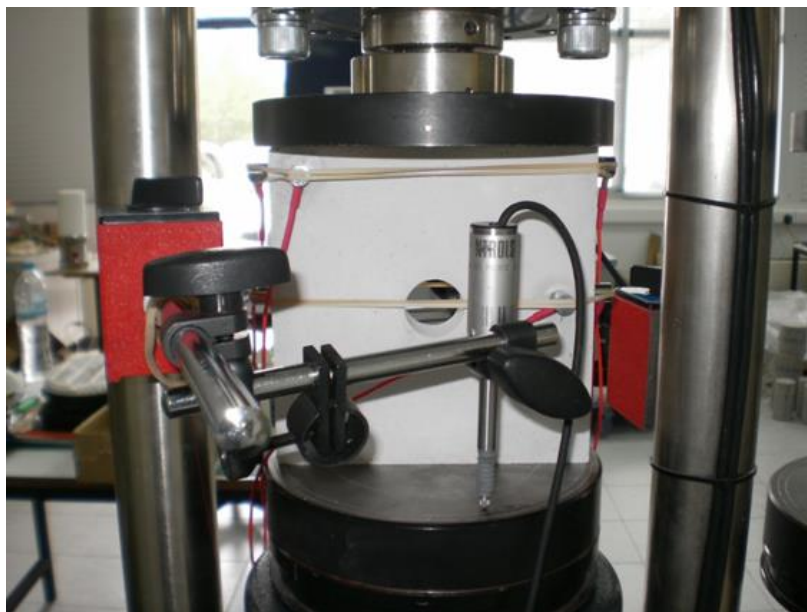
Εικόνα 50 - Τυπική διάταξη μονοαξονικής θλίψης γύψινου φυσικού μοντέλου με σπή. Το πλαίσιο θλίψης στο οποίο πραγματοποιήθηκαν όλες οι δοκιμές ήταν το πλαίσιο με έμβολο δυναμικότητας 250 kN. Στην εικόνα διακρίνονται το εμπρόσθιο βελόμετρο για τη μέτρηση της ανύψωσης της κάτω χαλύβδινης πλάκας καθώς επίσης και οι αισθητήρες της εμπρόσθιας όψης της πλάκας
