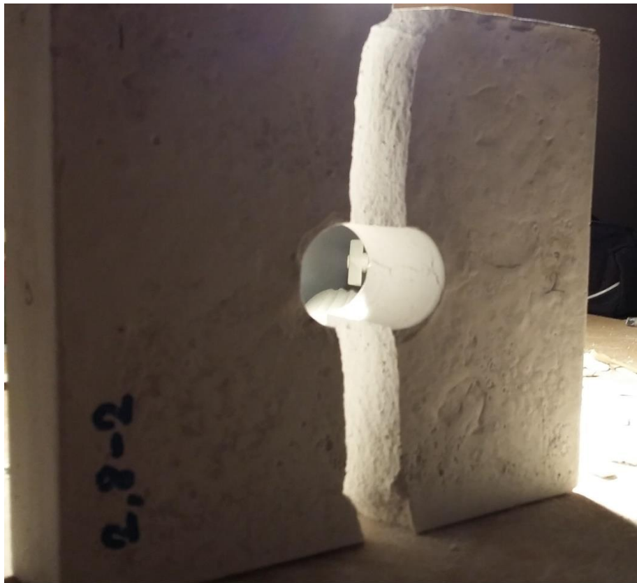
Εικόνα 64 - Θραύση του δοκιμίου στη μέση λόγω εφελκυστικής ρωγμής
