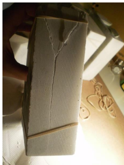
Εικόνα 82 - Ρωγμάτωση στα όρια της σχιστότητας του μαρμάρου
