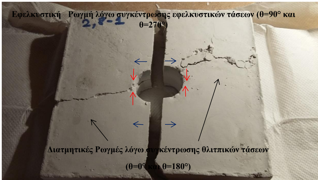
Εικόνα 61 - Δημιουργία εφελκυστικών και διατμητικών ρωγμών
