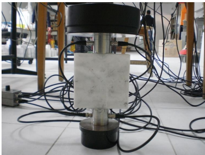
Εικόνα 71 - Μέτρηση των κυμάτων υπερήχων ( V_P και V_S )
