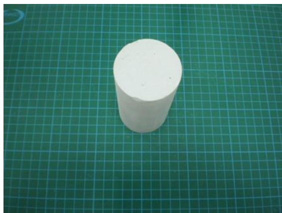
Εικόνα 36 - Κυλινδρικό δοκίμιο από μείγμα γύψου-τσιμέντου διαστάσεων 12 x 5,5 cm
