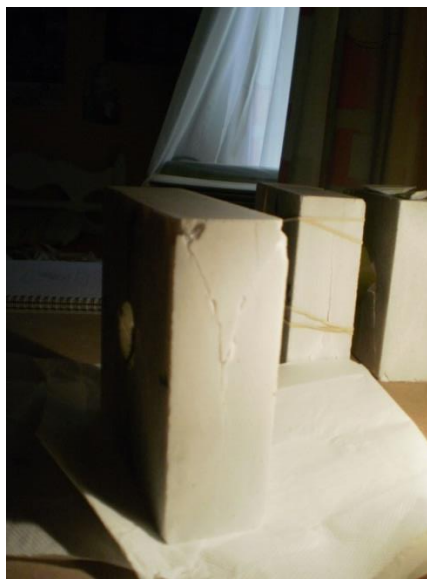
Εικόνα 94 - Ρωγμάτωση στα όρια της σχιστότητας
