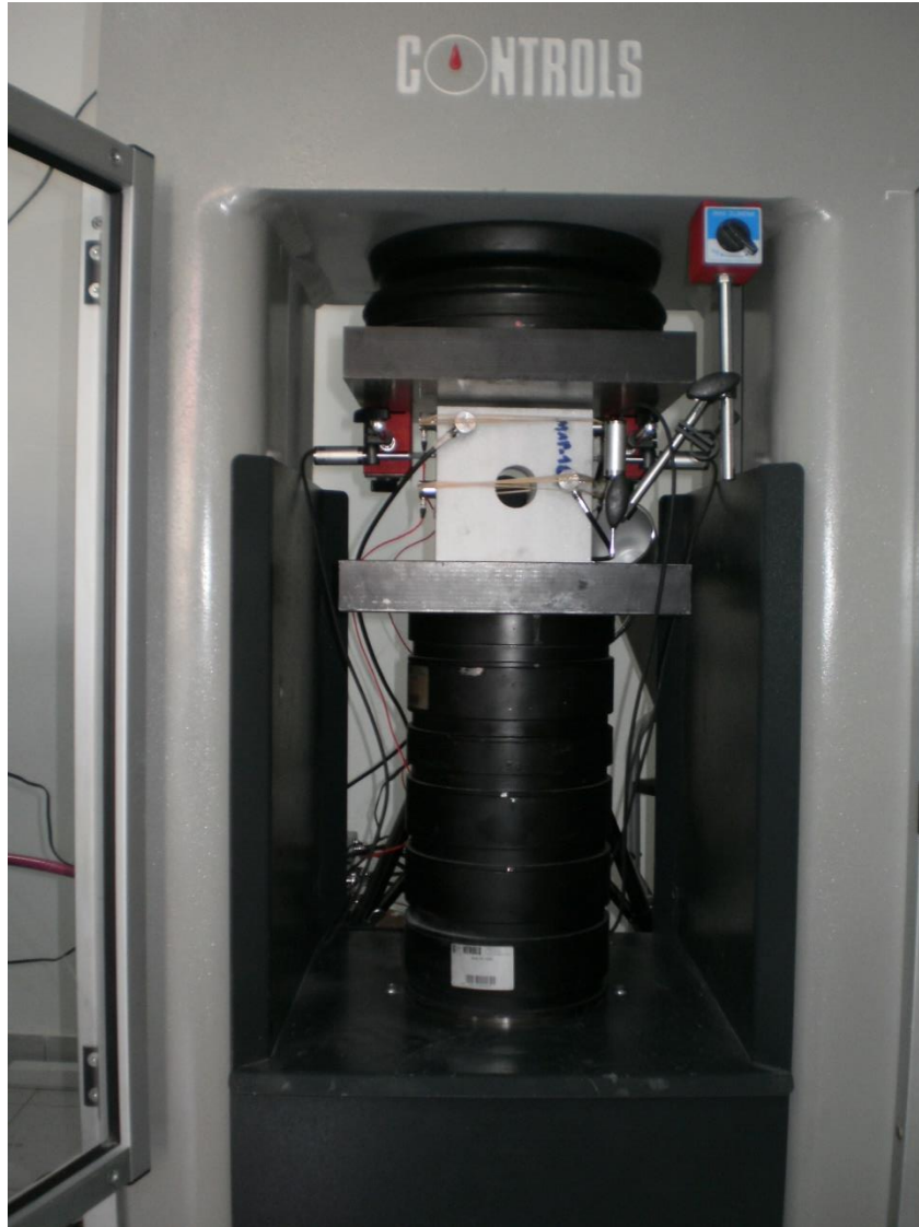
Εικόνα 70 - Τυπική διάταξη μονοαξονικής θλίψης των φυσικών μοντέλων με σπή από μάρμαρο Διονύσου
