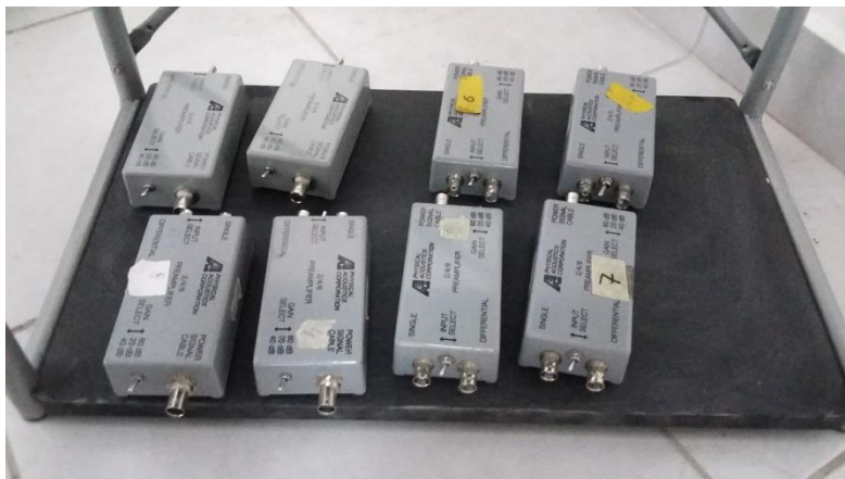
Εικόνα 28 - Προενισχυτές τύπου PAC 2/4/6 στο Εργαστήριο Τεχνολογίας Διάνοιξης Σηράγγων στο Ε.Μ.Π.
