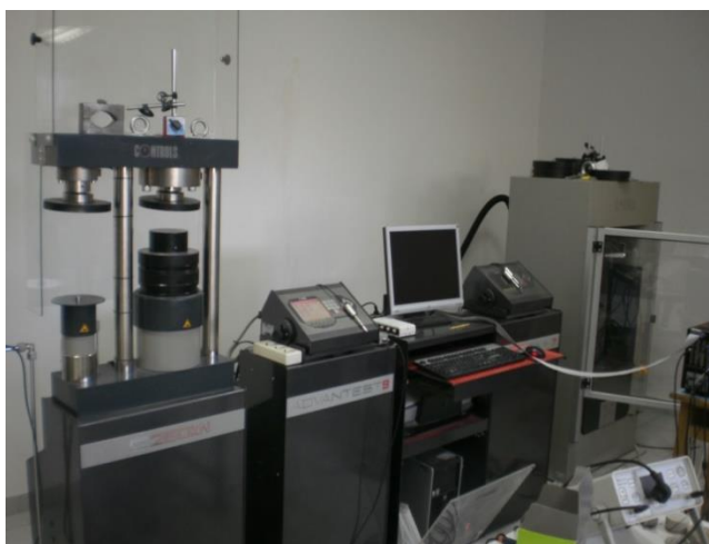
Εικόνα 23 - Σερβοϋδραυλική μηχανή του Εργαστηρίου Τεχνολογίας Διάνοιξης Σηράγγων στο Ε.Μ.Π.
