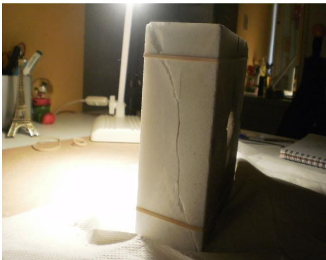
Εικόνα 81 - Ρωγμάτωση στα όρια της σχιστότητας του μαρμάρου
