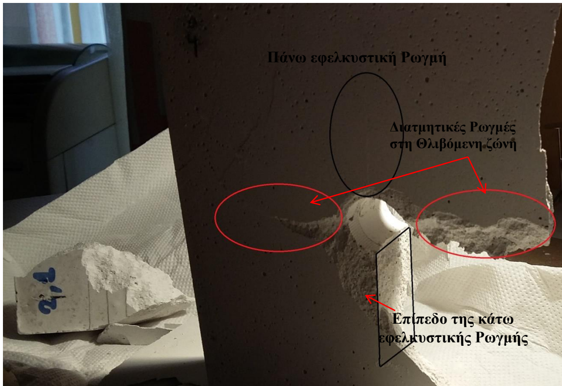
Εικόνα 59 - Εφελκυστικές και θλιπτικές ζώνες ρωγμάτωσης
