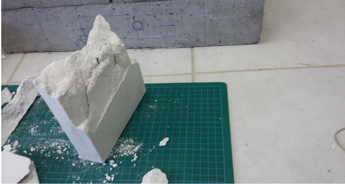
Εικόνα 66 - Θραύση της 1 ης πλάκας χωρίς σπή
