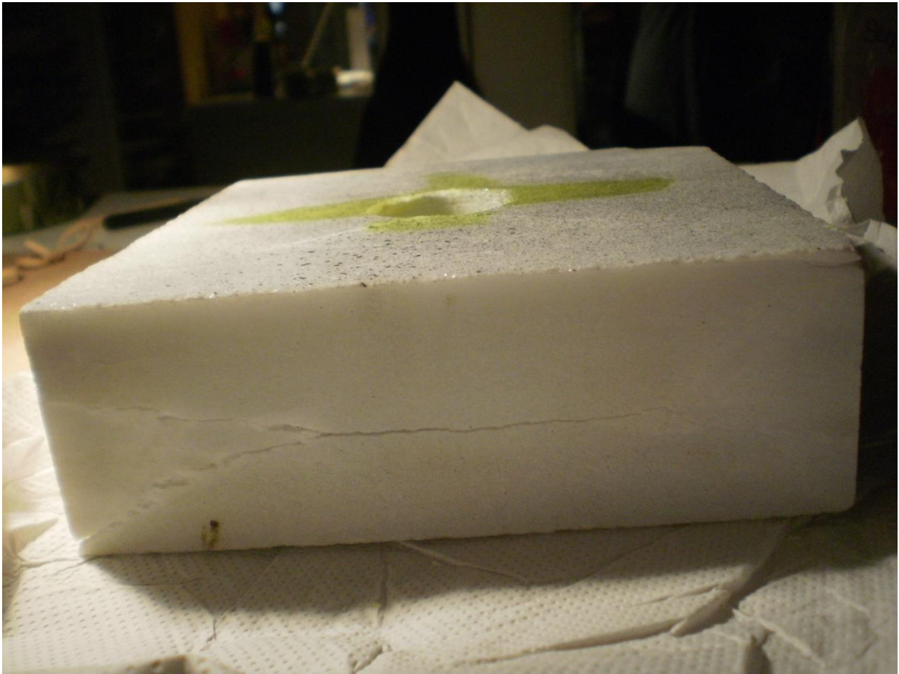
Εικόνα 91 - Αστοχία του δοκιμίου στα όρια της σχιστότητας του δοκιμίου
