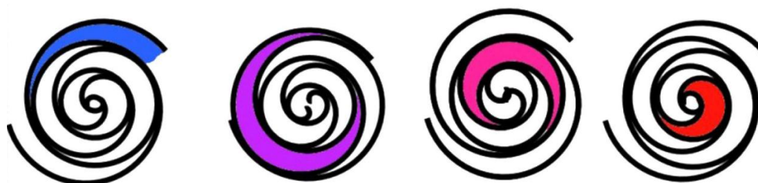
Εικόνα 3.2.1.1.1: Αρχή λειτουργίας του σπειροειδούς συμπιεστή [1].
