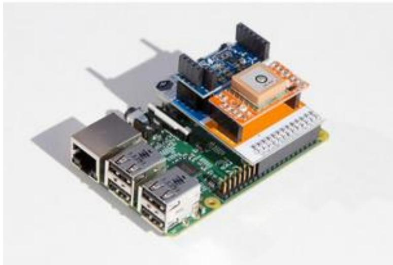
**Εικόνα 2: Το Raspberry Pi συνδεδεμένο με το GPS και το επιταχυνσιόμετρο**
