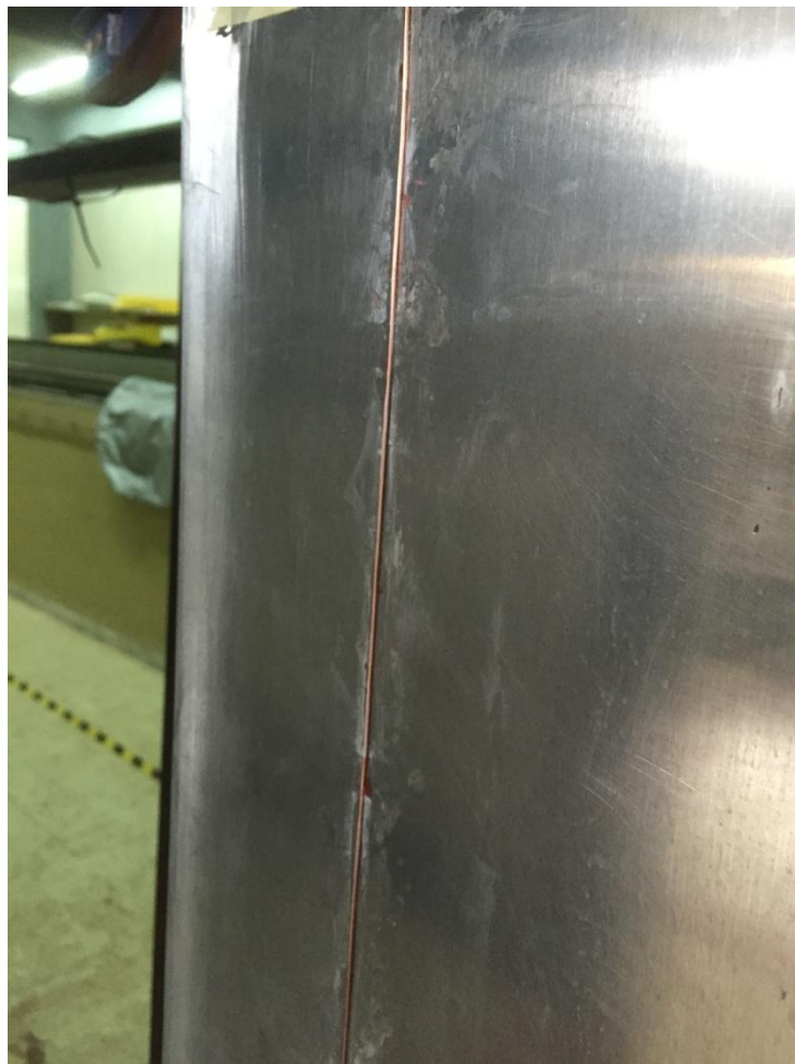
Εικόνα 5: Χάλκινο σύρμα διαμέτρου 1.0mm ως διεγέρτης τύρβης σε απόσταση 10cm από το άκρο πρόσπτωσης
