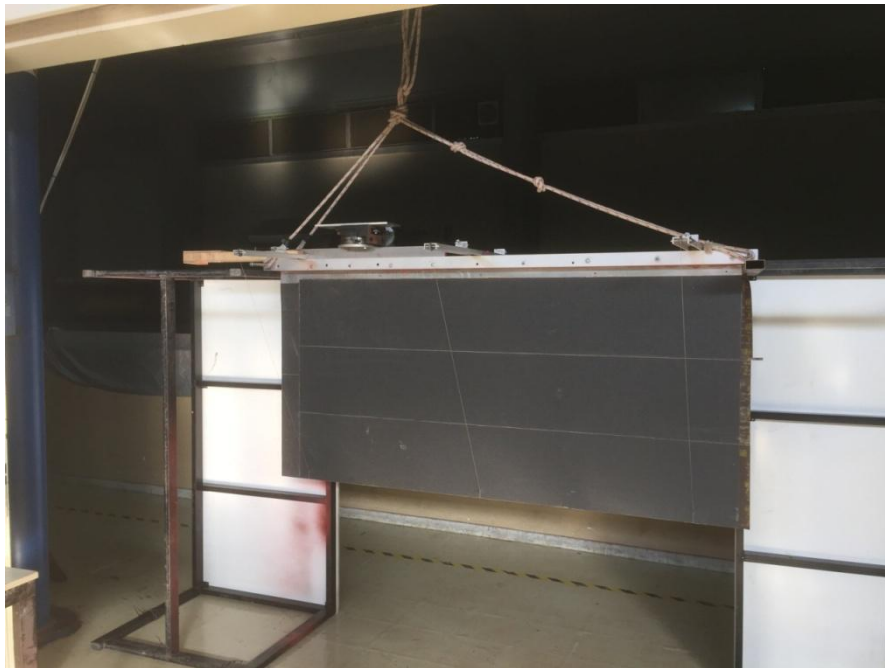
Εικόνα 10: Ολόκληρη η πλάκα καλυμμένη με γυαλόχαρτο grit-80
