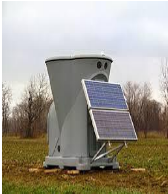
Σχήμα 2.9: Μετρητικό όργανο SODAR, εγκατεστημένο στην περιοχή της Κοζάνης (γ.π 40.301718°, γ.μ. 21.8000835°)
