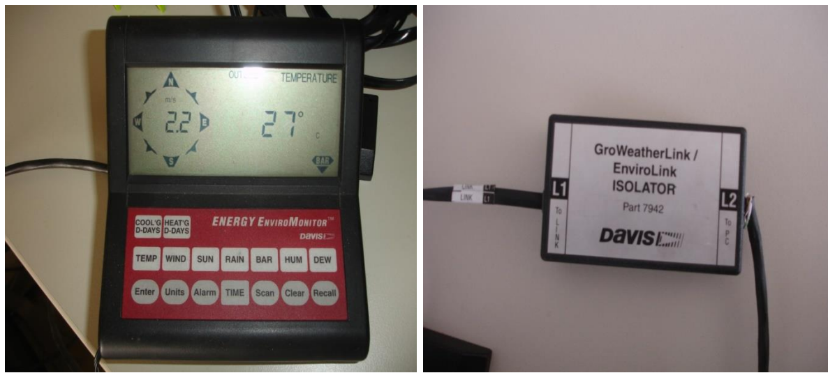
Σχήμα 2.8: Ηλεκτρονική κονσόλα και συσκευή μεταφοράς των κατακρατούμενων μεγεθών του μετεωρολογικού σταθμού Davis Instruments, εγκατεστημένα στο κτίριο ΑΝΥΜ,ΕΜΠ
