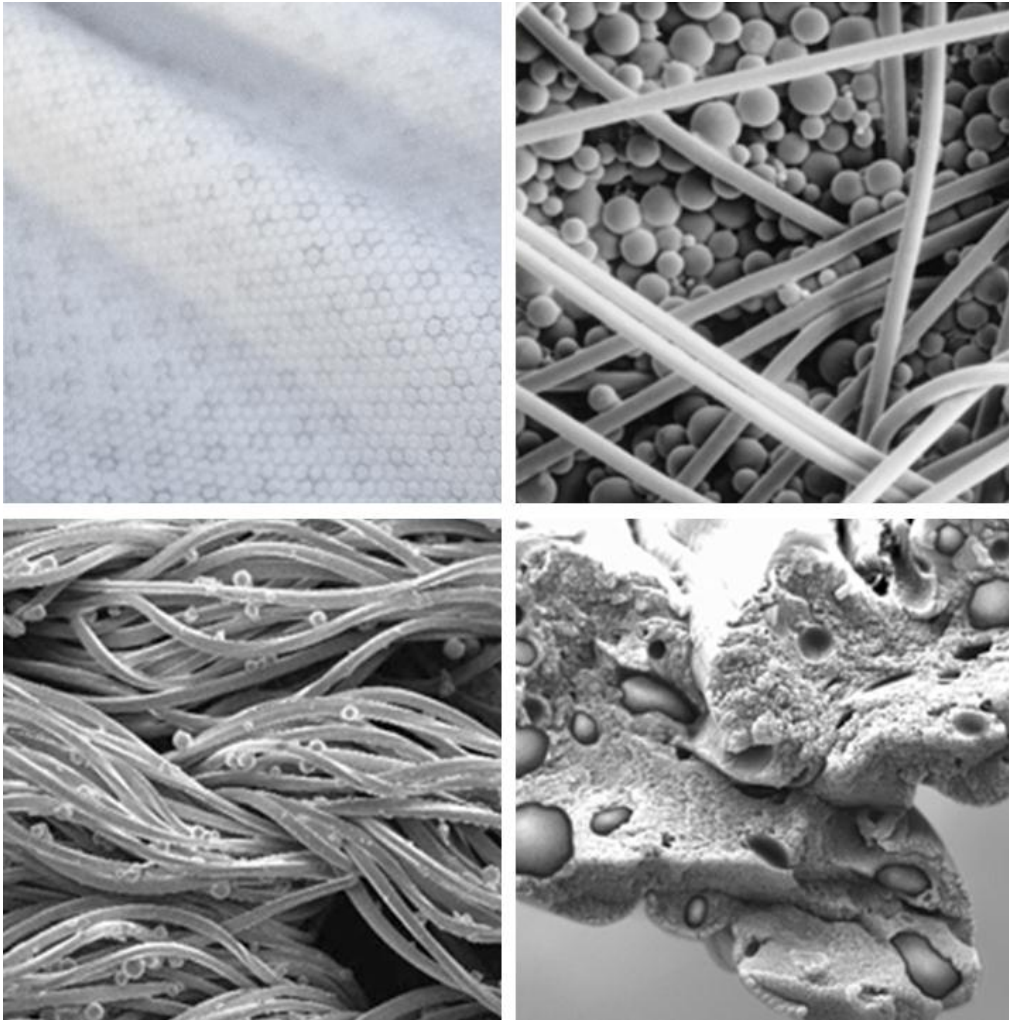
Σχήμα 4.10/2 : Δομή υφασμάτων με ενσωματωμένες μικροκάψουλες PCM
