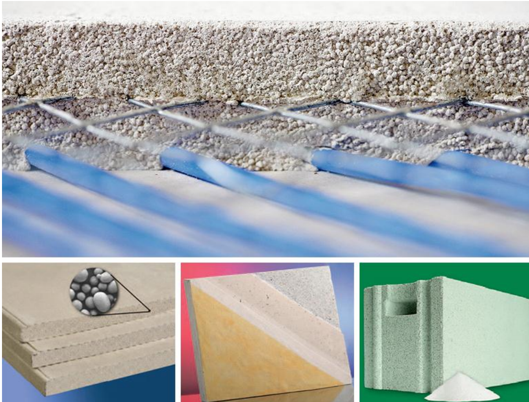
Σχήμα 4.2.3/1 : Εμβάπτιση PCM σε τοιμέντο, σανίδες, πλάκες
