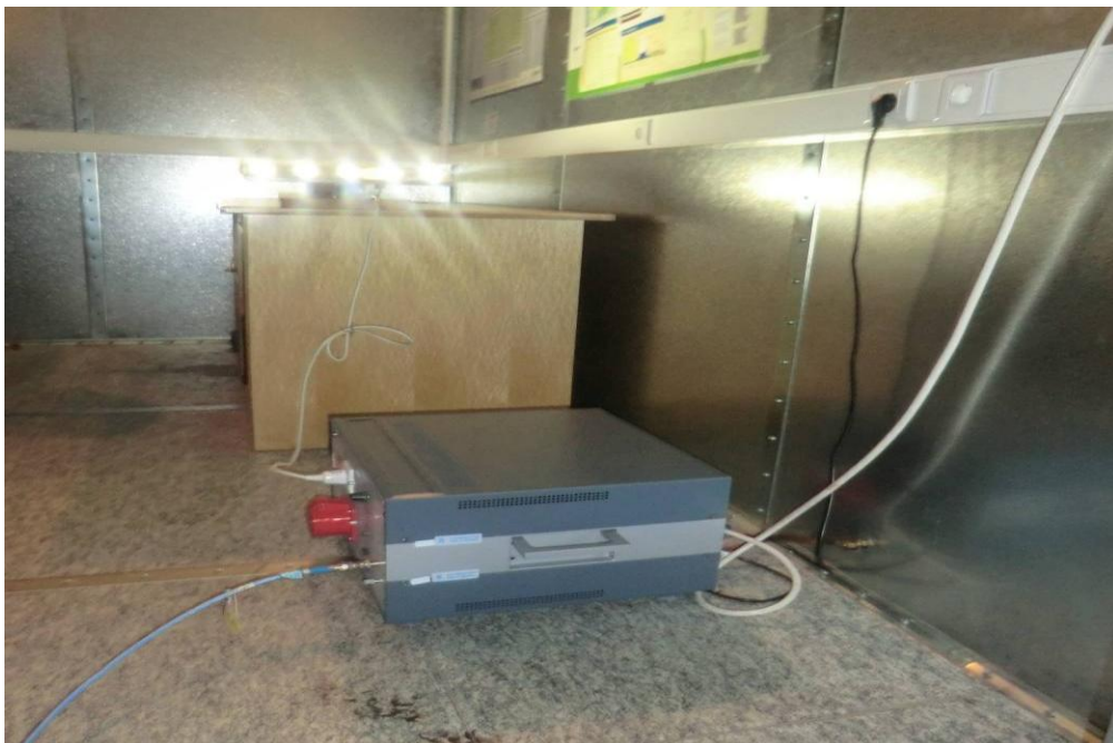
Σχήμα 4-11: Συνδεσμολογία δοκιμής μέτρησης αγόμενων ραδιοδιαταραχών στο εργαστήριο
