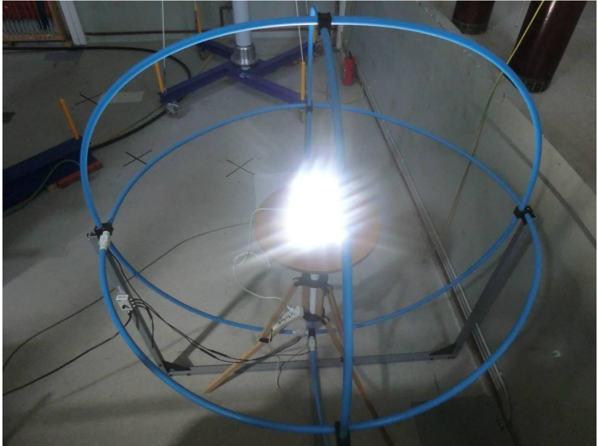
Σχήμα 4-2: Τοποθέτηση φωτιστικού στο κέντρο της βροχοκεραίας
