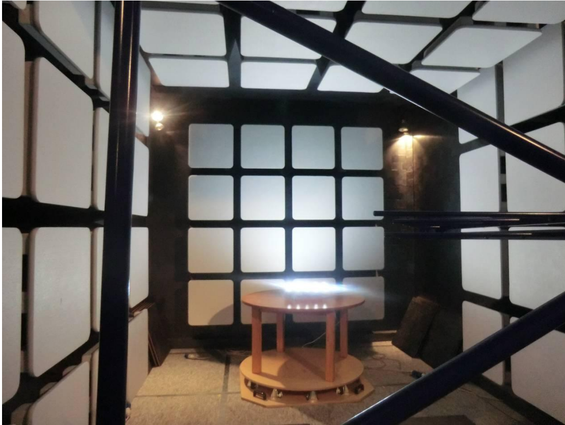
Σχήμα 4-5: Συνδεσμολογία δοκιμής μέτρησης εκπεμπόμενων ραδιοδιαταραχών στο εργαστήριο
