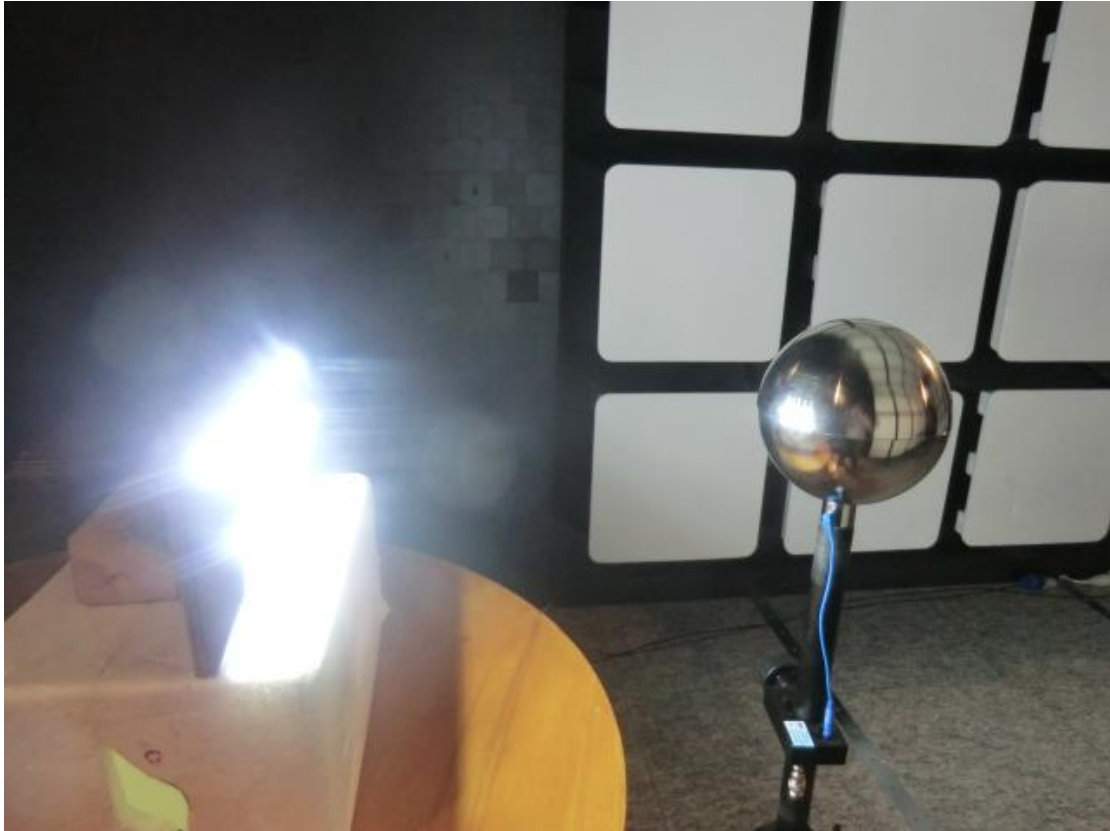
Σχήμα 4-14: Συνδεσμολογία δοκιμής Van der Hoofden στο εργαστήριο
