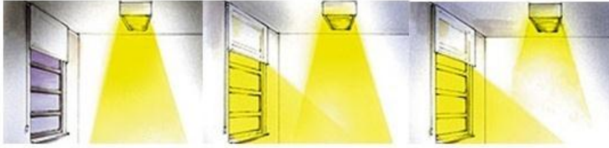
Σχήμα 4.9 Μείωση του τεχνητού φωτισμού με αξιοποίηση του φυσικού φωτισμού. Πηγή: Κέντρο Ανανεώσιμων Πηγών Ενέργειας (ΚΑΠΕ).
