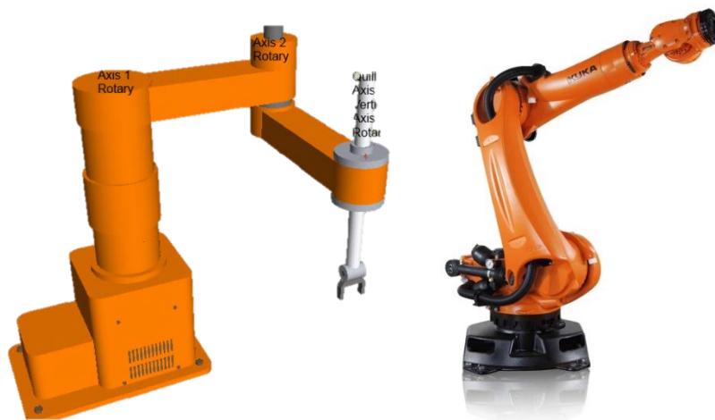
Σχήμα 1.7: Αρθρωτά και SCARA ρομπότ.
