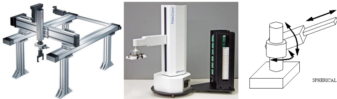
Σχήμα 1.6: Καρτεσιανά, κυλινδρικά και σφαιρικά/πολικά ρομπότ.
