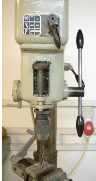
Σχήμα 4.25: Κάθετο δρόπανο για δημιουργία οπών.
