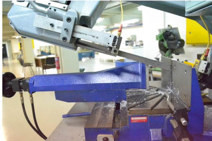
Σχήμα 4.30: Κορδέλα-Πριόνι κοπής, περιστροφικής κίνησης.
