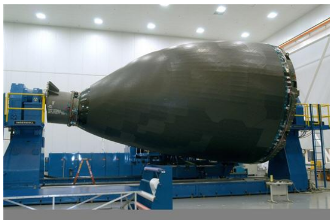
Σχήμα 1.20: Ατράκτος του Boeing 787,
