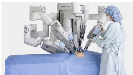
Σχήμα 1.8: Χειρουργικό ρομπότ Da Vinci.
