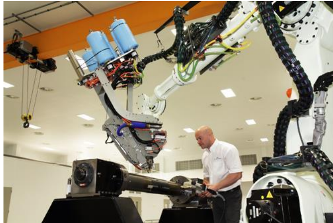
Σχήμα 2.4: Αυτοματοποιημένη κεφαλή με 4 μπομπίνες (πηγή: AMRC).
