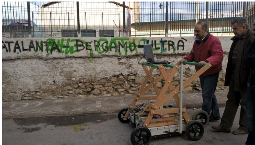
Εικόνα 5.12 Κάναβος μετρήσεων GPR
