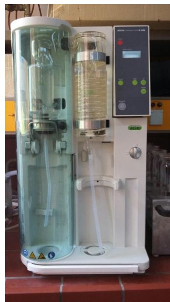
Εικόνα 4.15: Συσκευή απόσταξης Kjeldahl
