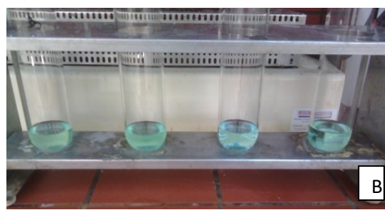
Εικόνα 4.14: Σωλήνες καύσης αμέσως μετά την ολοκλήρωση της καύσης (A) και αφότου ψυχθούν (B) σε θερμοκρασία δωματίου
