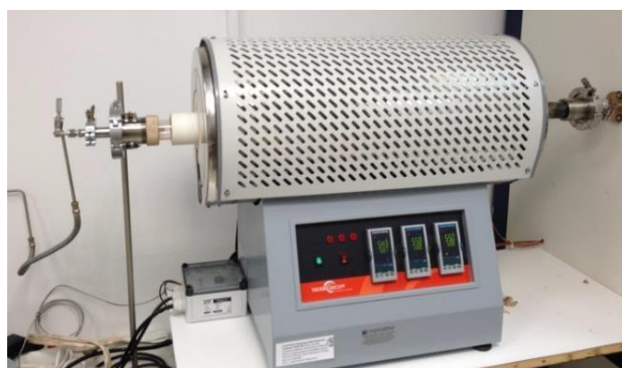
Εικόνα 24. Διάταξη συστήματος υποστηριγμένου καταλύτη
