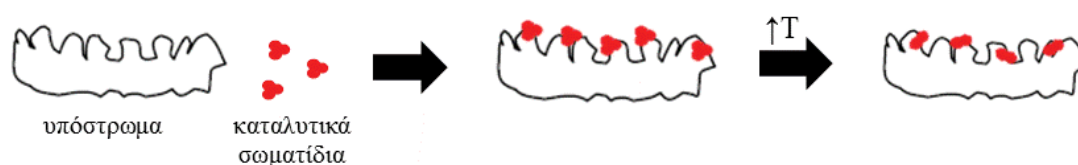
Εικόνα 7. «Αλληλεπιδράσεις» μεταξύ υποστρώματος και καταλυτικών σωματιδίων
