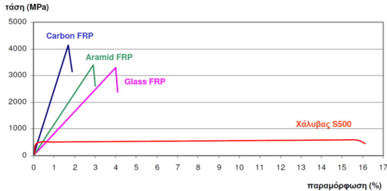
Σχήμα 10.38 Εφελκυστική αντοχή διαφόρων τύπων FRP και χάλυβα
