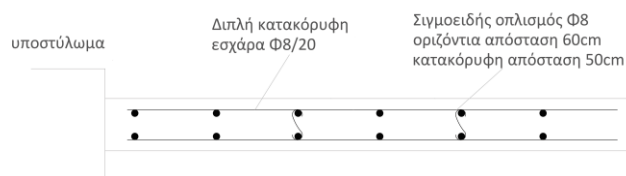
Σχήμα 11.2 Διατομή τοιχείων Τ1, Τ2, Τ3 (15 × 140)
