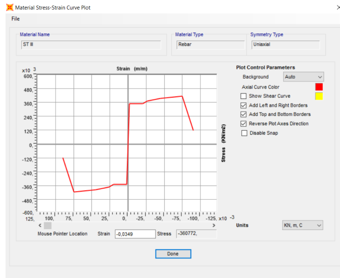
Σχήμα 6.18 Διάγραμμα τάσεων παραμορφώσεων χάλυβα οπλισμού (Simple)
