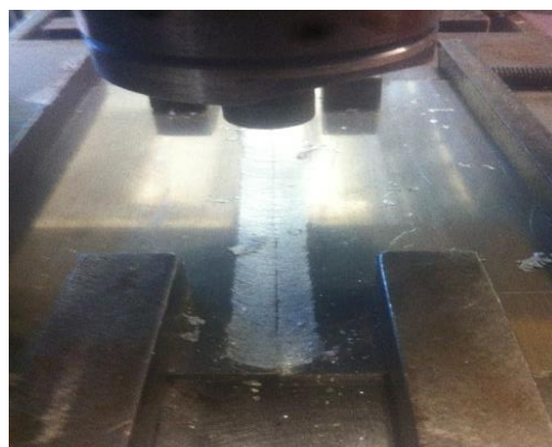
Σχήμα II.11 Πάσο με εργαλείο χωρίς πείρο για να εγκλωβιστεί η σκόνη ενίσχυσης μέσα στο αυλάκι
