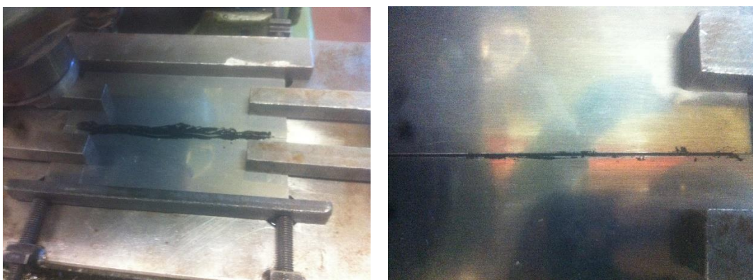
Σχήμα II.10 Εισαγωγή της σκόνης ενίσχυσης μέσα στα προς συγκόλληση ελάσματα
