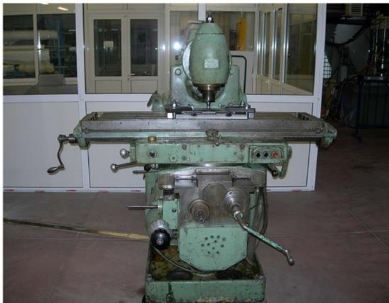
Σχήμα II.5 Η μηχανή της συγκόλλησης δια τριβής με ανάδευση και οι δυνατές ταχύτητες συγκόλλησης και περιστροφής του εργαλείου συγκόλλησης.
