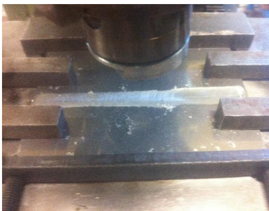
Σχήμα II.11 Πάσο με εργαλείο χωρίς πείρο για να εγκλωβιστεί η σκόνη ενίσχυσης μέσα στο αυλάκι
