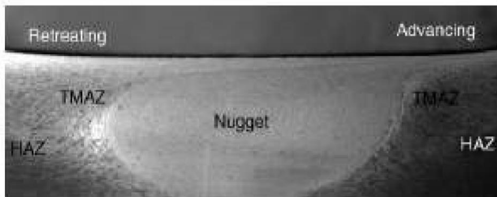
Σχήμα 1.8 Διάφορες ζώνες μικροδομής σε FSP κατεργασμένο κράμα Al7075-T651 (σπειροειδής πείρος, 400rpm, 51 mm/min)
