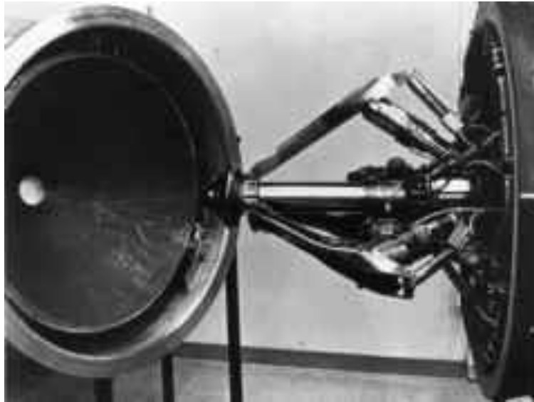
Σχήμα 1.7 Κεντρικό σύστημα πρόσδεσης.
