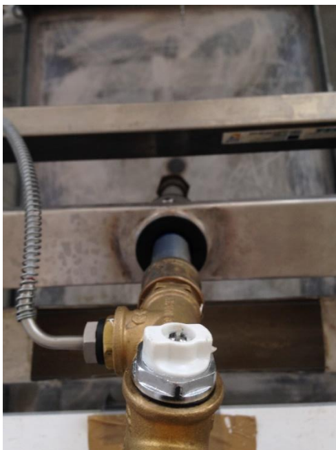
Εικόνα 4.2: Αγωγός εκροής, με σύστημα εξαέρωσης και μετρητή θερμοκρασίας πριν την έξοδο της φλέβας.
