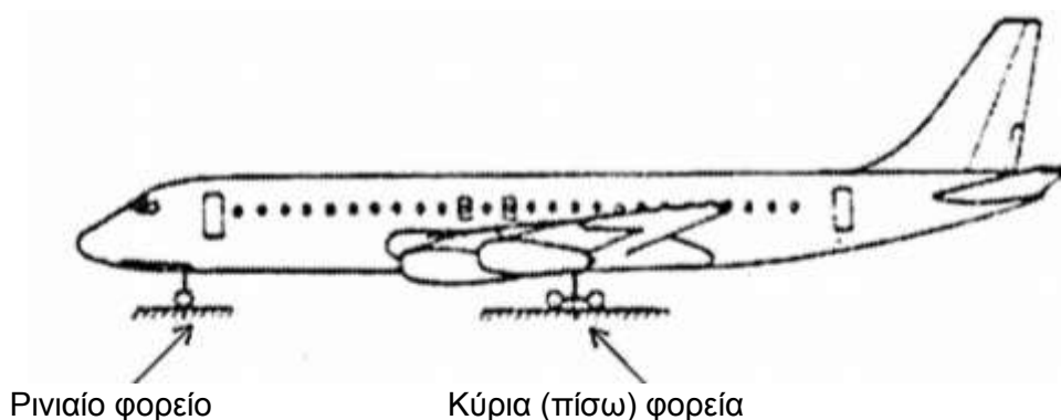
Σχήμα 2.6: Κατανομή βάρους αεροσκάφους μεταξύ ρινιαίου και κυρίων φορειών
