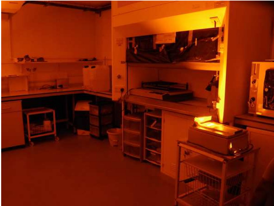
Εικόνα 5. 13: Χημική επεξεργασία δειγμάτων υπό συνθήκες ασθενούς κιτρινέρυθρου φωτισμού.
