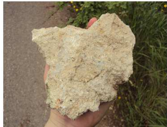
Εικόνα 4. 7: Δειγματοληψία από συμπαγές υλικό ως μπλοκ πετρώματος με τη χρήση γεωλογικού σφυριού (Δειγματοληψία υπαίθρου, Μάϊος 2011).
