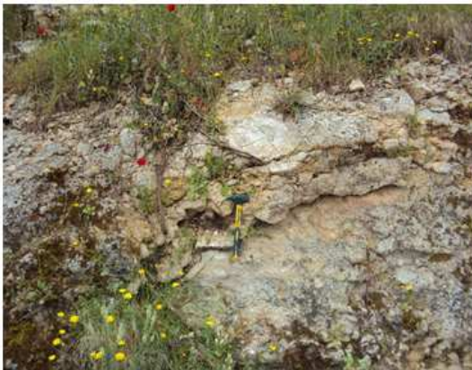
Εικόνα 4. 7: Δειγματοληψία από συμπαγές υλικό ως μπλοκ πετρώματος με τη χρήση γεωλογικού σφυριού (Δειγματοληψία υπαίθρου, Μάϊος 2011).
