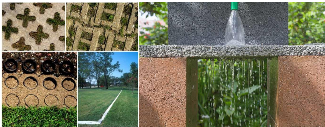
Εικόνα 2.20: Τα πορώδη φυσικά ή τεχνητά υλικά εδαφοκάλυψης ελαχιστοποιούν τη διατάραξη του κύκλου του νερού και επιτρέπουν την ανάπτυξη βλάστησης στους αρμούς τους
