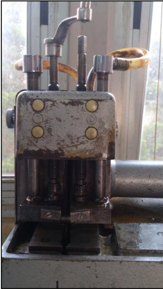
Εικόνα 4-2: Μηχανή κοπής δοκιμίων, Struers Discotom.
