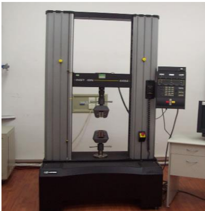
Εικόνα 4-12: Μηχάνημα εφελκυσμού Instron 4482.
