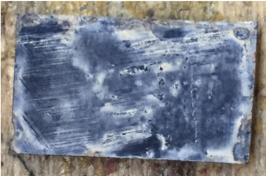
Εικόνα 4-6: Δοκίμιο Θερμικής Κατεργασίας στους 1150 °C/ 30 λεπτά/ Βαφή σε νερό.
