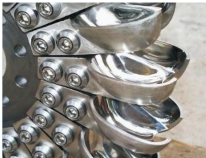
Εικόνα 2.11 Πτερωτή υδροστροβίλου τύπου Pelton και μορφή σκαφιδίων (Πηγή: http://www.hydrohrom.cz/EN/horizontal-compact-pelton-turbine.html )
