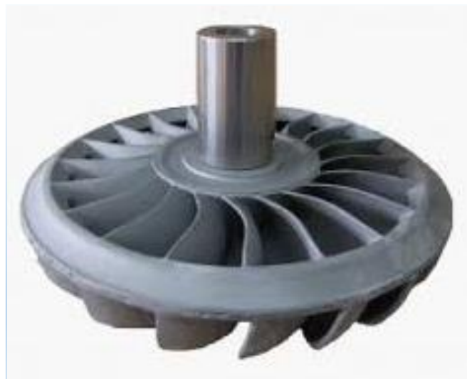
Εικόνα 2.13 Δρομέας υδροστροβίλου Turgo (Πηγή: http://www.microhydropower.com )
