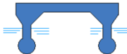
Σχήμα 3.6: Εγκάρσια τομή SWATH
