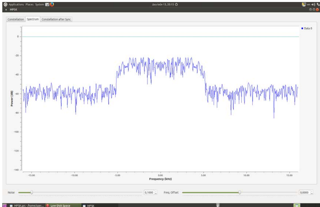
Σχήμα 3.17 - Φάσμα μετά τη διαμόρφωση DBPSK
