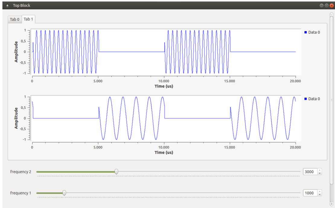
Σχήμα 3.37 - Τα δύο διαφορετικά σήματα που αποτελούν τη διαμόρφωση FSK
