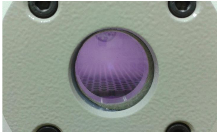
Εικόνα 6: Ο θάλαμος του PlasmaEtcher του Εργαστηρίου Εμβιομηχανικής και Συστημικής Βιολογίας κατά την διεργασία του πλάσματος ατμοσφαιρικού αέρα
