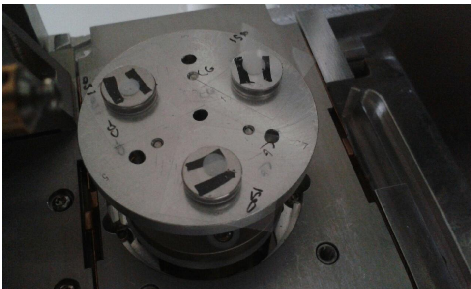
Εικόνα 12: Τοποθέτηση ικριωμάτων στην βάση για την έναρξη της ηλεκτρονικής μικροσκοπίας σάρωσης
