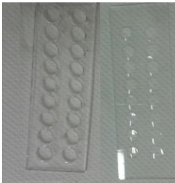
Εικόνα 8: Έγχυση σταγόνων νερού μετά από κατεργασία γυαλιού (δεξιά) με ατμοσφαιρικό πλάσμα. Το γυαλί ήταν καλυμμένο με μάσκα PDMS (αριστερά) έτσι ώστε μόνο συγκεκριμένα σημεία του να γίνουν υδρόφιλα.
