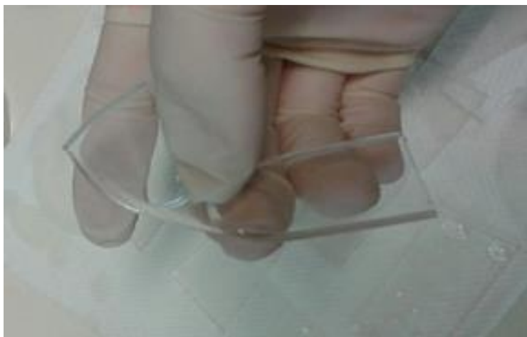
Εικόνα 11: (αριστερά) Ελαστικότητα φύλλον PDMS, (δεξιά) Φύλλο PDMS με οπές για εφαρμογή στην κατασκευή της τρισδιάστατης well-plate
