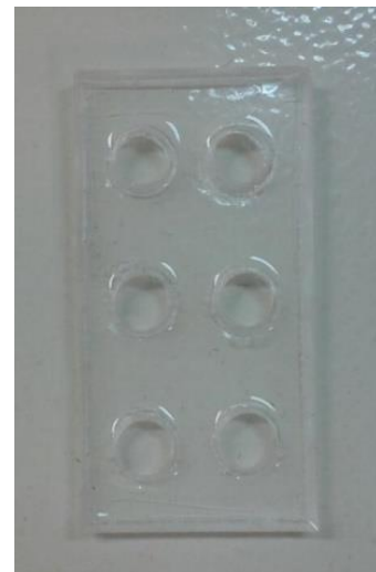
Εικόνα 11: (αριστερά) Ελαστικότητα φύλλον PDMS, (δεξιά) Φύλλο PDMS με οπές για εφαρμογή στην κατασκευή της τρισδιάστατης well-plate
