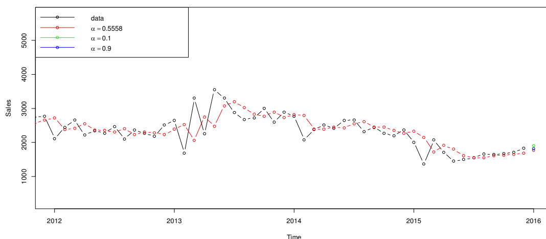
Εικόνα 4.2-7: Προβλέψεις με τη μέθοδο απλής εκθετικής εξομάλυνσης με εφαρμογή στο παράδειγμα των πωλήσεων
