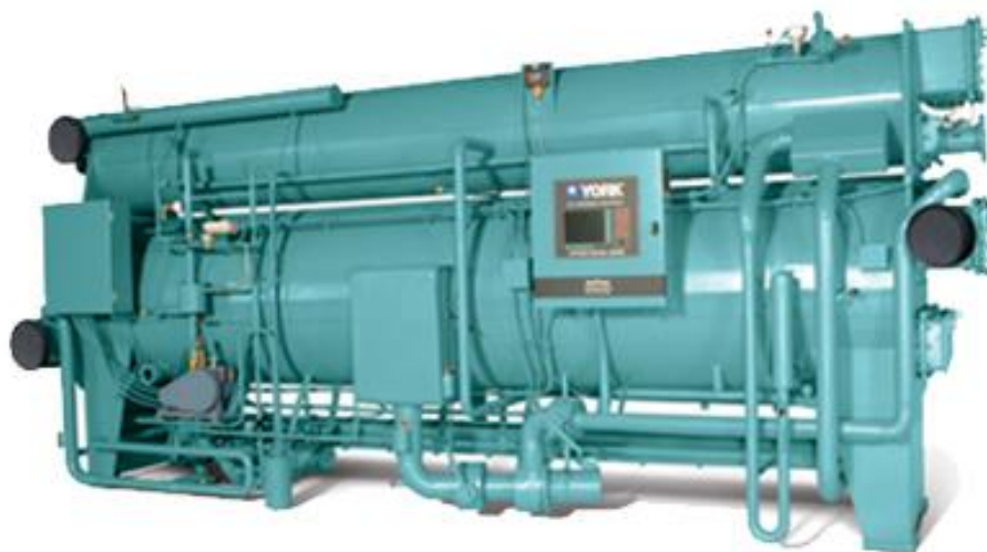
Εικόνα 1.4-1: Ψύκτης απορρόφησης μίας βαθμίδας LiBr-H 2 O τροφοδοτούμενος με ζεστό νερό ή ατμό με δυνατότητες ψυκτικής ισχύος 420-4840 kW της εταιρίας York International 7
