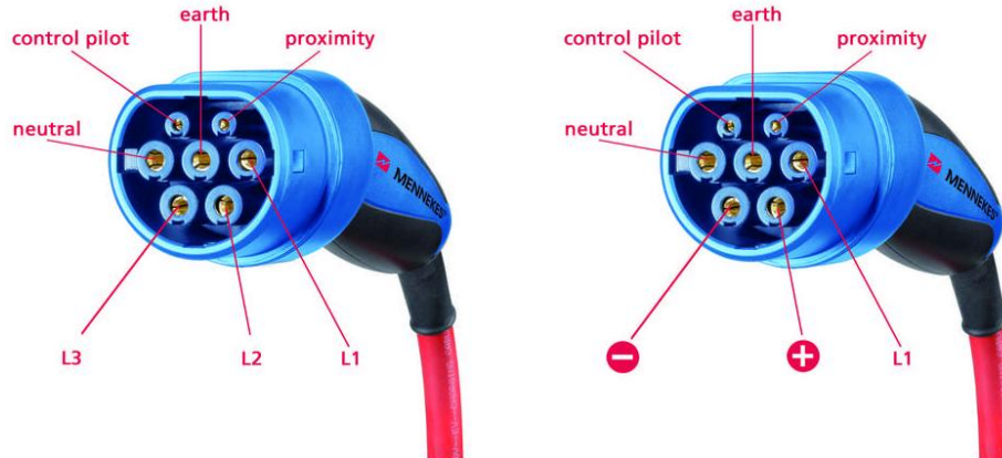
Εικόνα 1. 14 Βύσματα τύπου 2, AC αριστερά και DC δεξιά.
