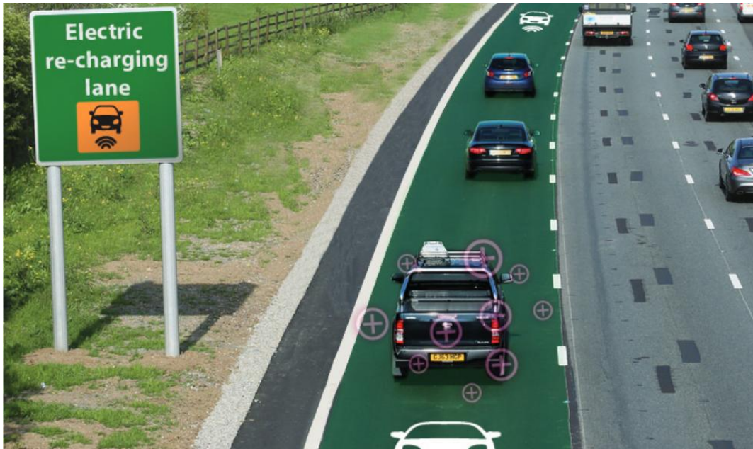
Εικόνα 1. 11 Επαγωγική φόρτιση ηλεκτρικών οχημάτων σε λωρίδα αυτοκινητόδρομου
