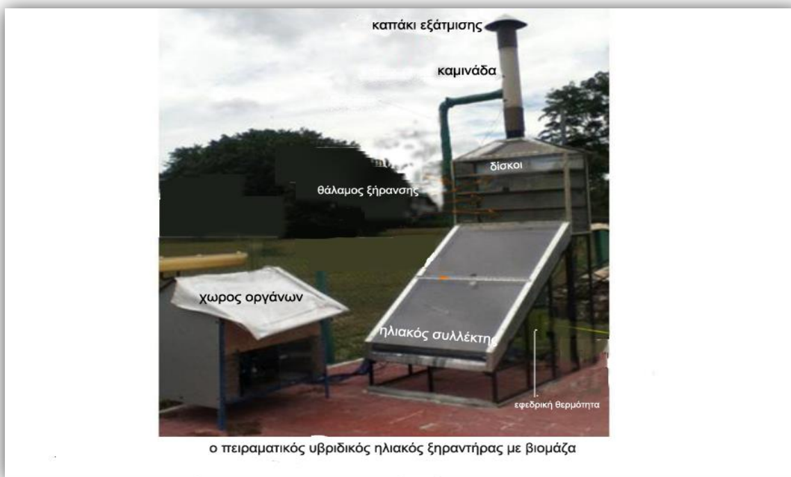
Σχ. 120 [240]Ο πειραματικός υβριδικός ηλιακός ξηραντήρας με βιομάζα
