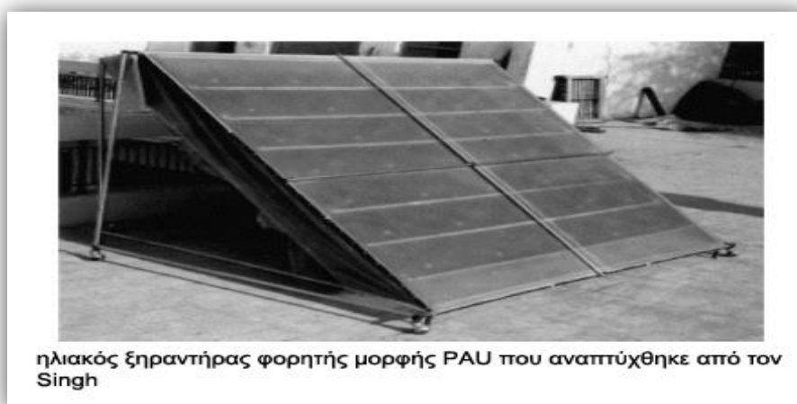
Σχ. 30 [128] ηλιακός ξηραντήρας φορητής μορφής PAU που αναπτύχθηκε από τον Singh
