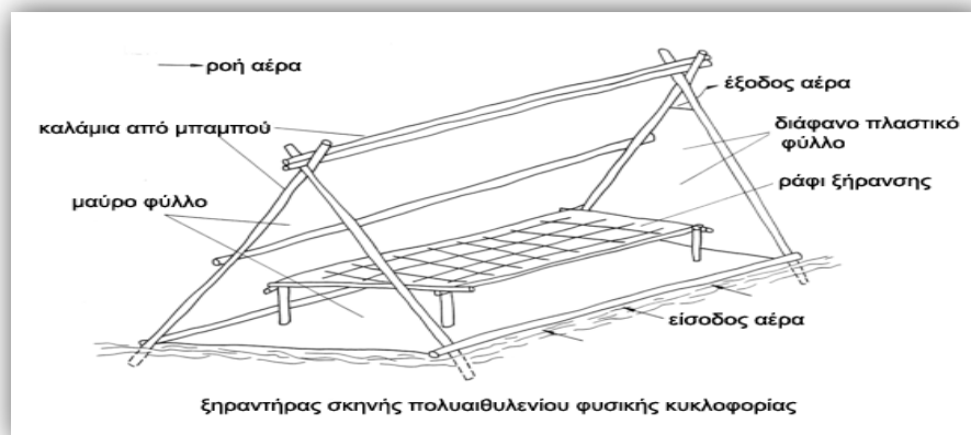
Σχ. 17 [32] Ξηραντήρας σκηνής πολυαιθυλενίου φυσικής κυκλοφορίας
