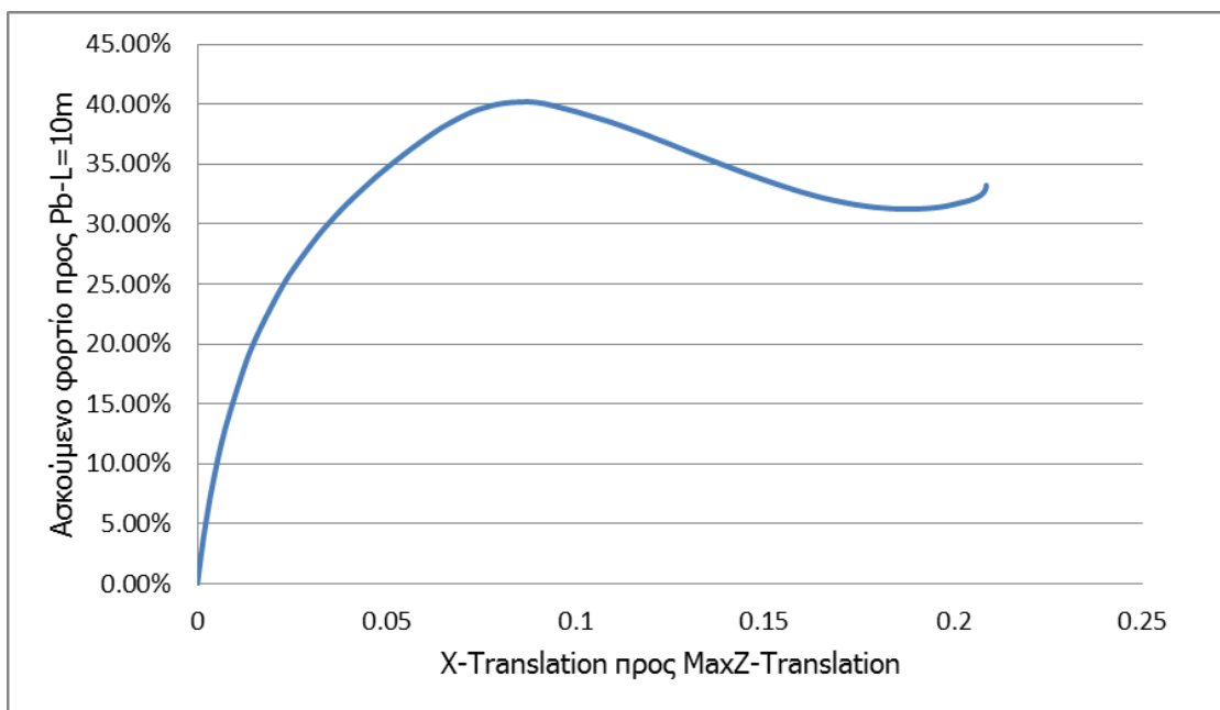
Σχήμα 7-30: Δρόμος ισορροπίας λόγω φορτίου προς αντοχή για L=20m -λόγου X μετατόπισης προς μέγιστη Z μετατόπιση για τον κόμβο αναφοράς της τεγίδας.
