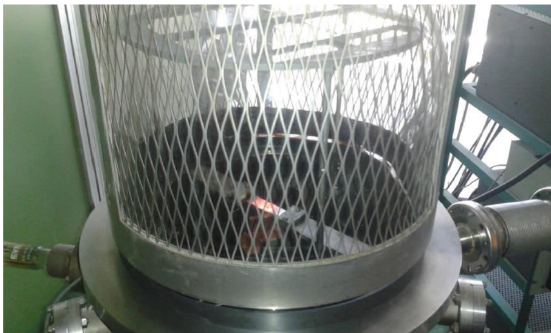
Εικόνα 2.6 Ο εξαχνωτήρας εν ώρα λειτουργίας
