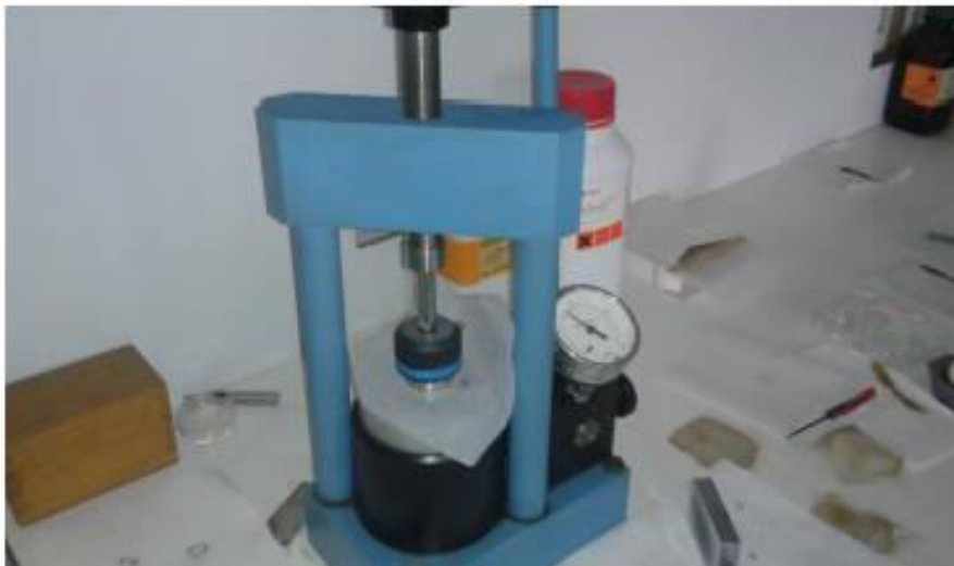
Εικόνα 2.5 Η πρέσα του Ινστιτούτου με την οποία κατασκευάσαμε τις παστίλιες
