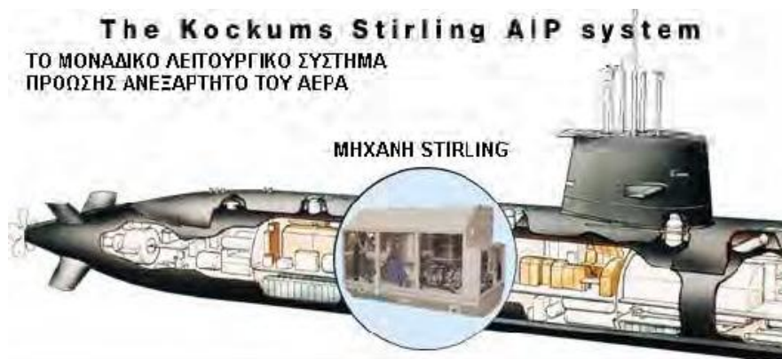
Σχήμα 1.17: Σύγχρονο Σουηδικό Υποβρύχιο με Μηχανή Stirling [27].
