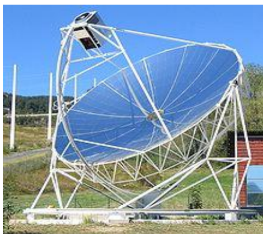
Σχήμα 1.15: Ηλιακή Μηχανή Stirling Ισχύος 10 kW εγκατεστημένη στη Γαλλία, Font-Romeu-Odeillo [24].
