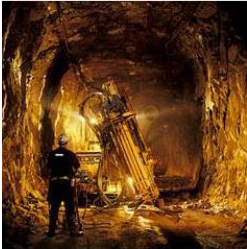
Εικόνα 4.1. Διάτρηση διατρημάτων για την εκμετάλλευση κοιτάσματος με τη μέθοδο της κατακρήμνισης οροφής
