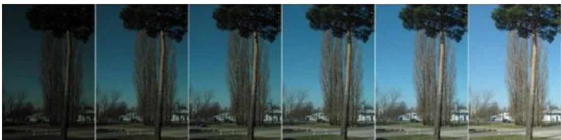
Σχήμα 4.19: Βαθμιαία μεταβολή χρώματος ενός θερμοχρωμικού laminated υαλοπίνακα.
