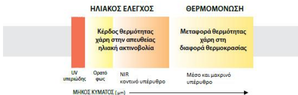
Σχήμα 3.9: Μήκη κύματος στα οποία αναφέρεται ο ηλιακός έλεγχος και η θερμομόνωση απέναντι στη μεταφορά θερμότητας με θερμική ακτινοβολία μεγάλου μήκους κύματος, σε έναν υαλοπίνακα.
