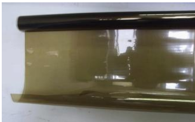
Σχήμα 4.9: Θερμοσταθερό PET φιλμ με επικάλυψη VO 2 .
