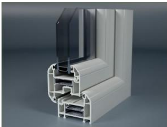
Σχήμα 3.26: Σχέδιο προφίλ κουφώματος παραθύρου, από uPVC, με ανοιγόμενο φύλλο διπλού υαλοπίνακα.
