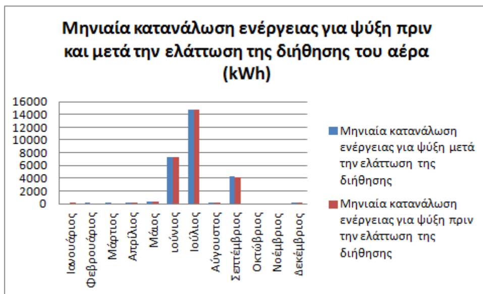
Εικ. 9.19 Διαφορές στην κατανάλωση ενέργειας για ψύξη μετά την ελάττωση της διήθησης του αέρα
