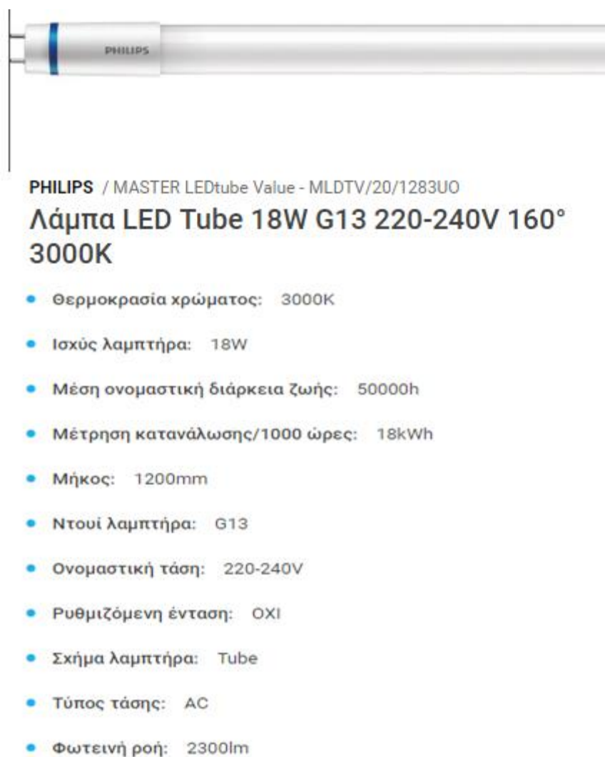
Εικ. 9.28 Τεχνικά χαρακτηριστικά λαμπτήρα PHILIPS/ MASTER LEDtube Value - MLDTV/20/1283UO
