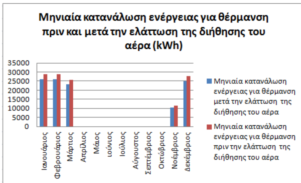
Εικ. 9.18 Διαφορές στην κατανάλωση ενέργειας για θέρμανση μετά την ελάττωση της διήθησης του αέρα
