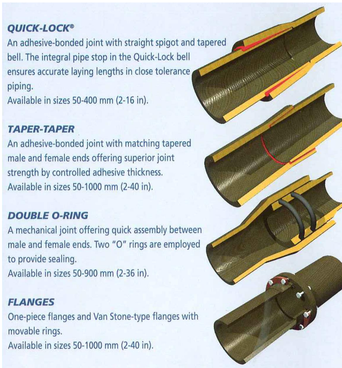
Σχήμα 3.30: Τρόποι σύνδεσης σωληνώσεων FRP, AMERON 2001
