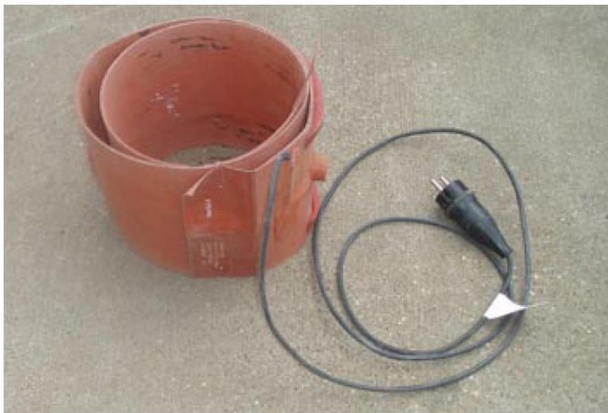
Σχήμα 3.27: «Κουβέρτα» θέρμανσης (heating blanket) για σκλήρυνση σωληνώσεων FRP, AMERON 2011
