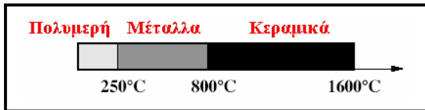
Σχήμα 2.9: Θερμοκρασιακά όρια χρήσης των υλικών
