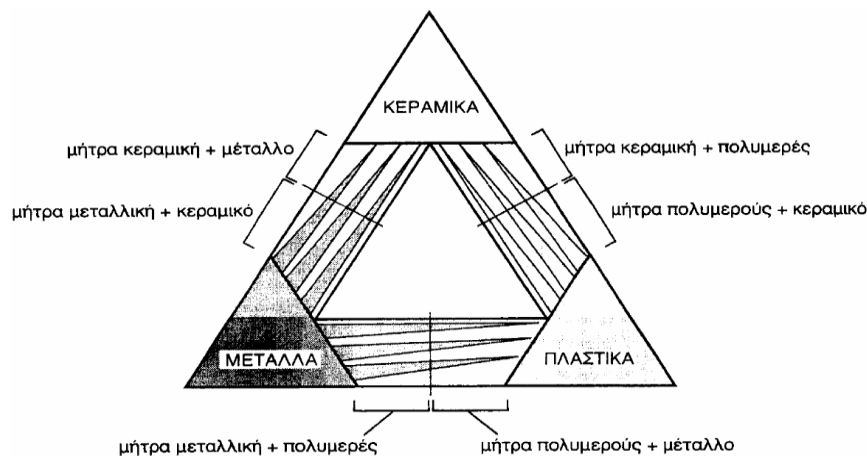
Σχήμα 1.1: Κατηγορίες σύνθετων υλικών ανάλογα με το υλικό της μήτρας και της ενίσχυσης
