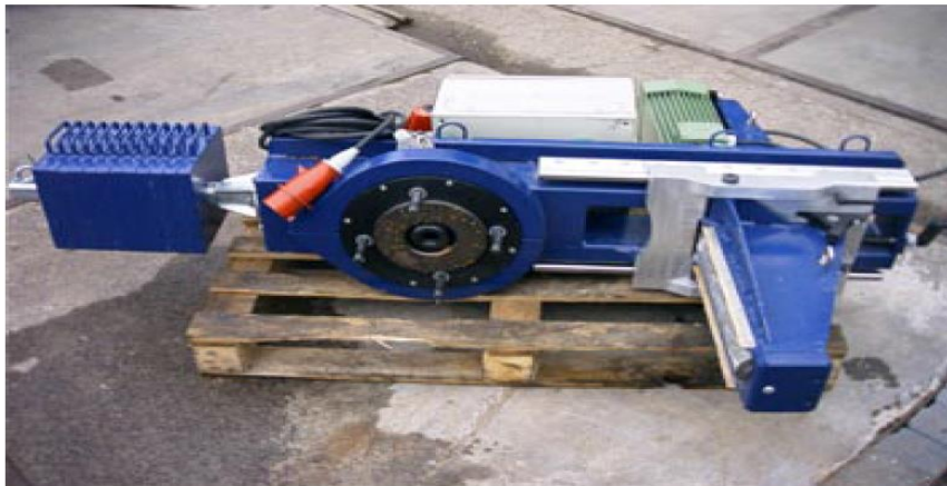
Σχήμα 4.12: Τροχός λείανσης σωληνώσεων FRP, AMERON 2011
