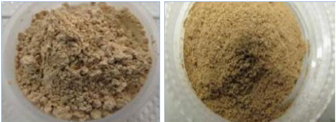
Σχήμα 3.5.2: Διατομίτης - σταθερής μορφής σύνθετο PCM παραφίνης / διατομίτη, [4]
