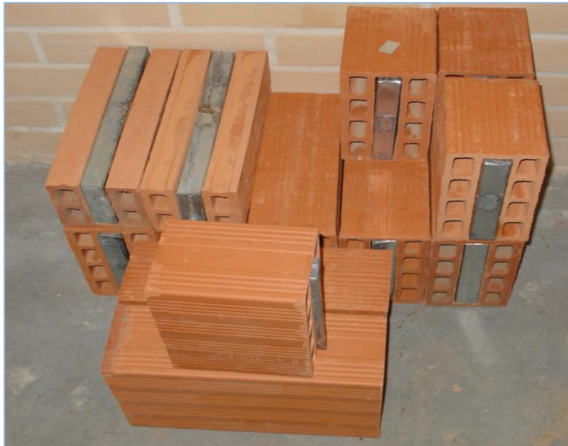
Σχήμα 4.2.1.9.1: Τούβλα με μακροκάψουλες PCM, [20]
