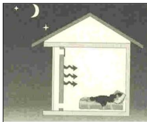
Σχήμα 1.2.2.1: Λειτουργία τοίχου Trombe, τον χειμώνα. [15]
