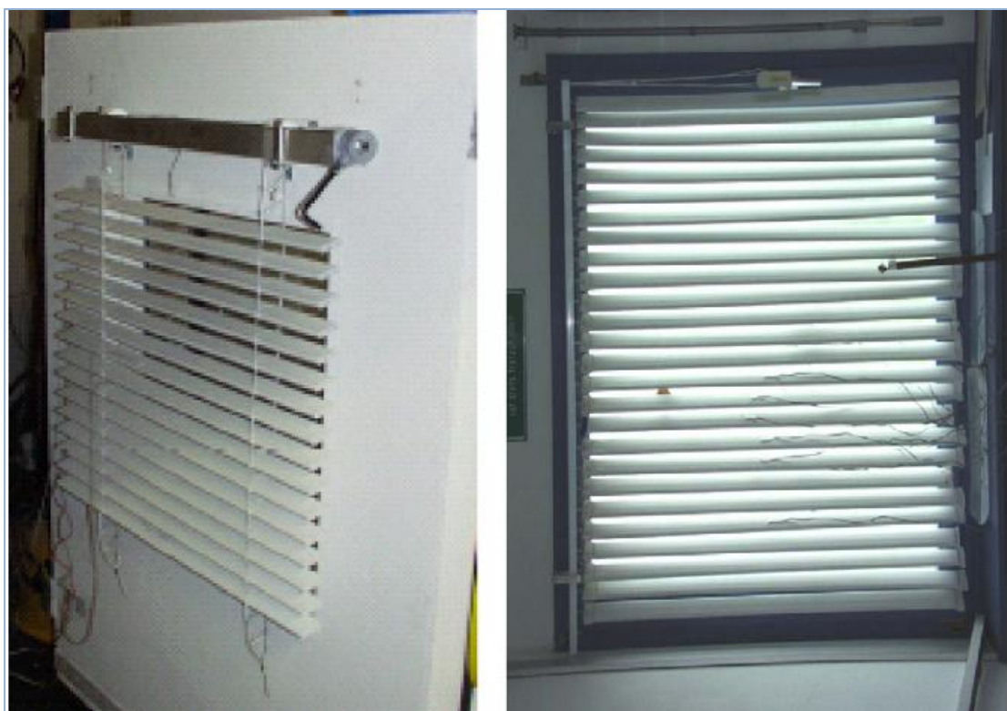
Σχήμα 4.2.1.3.2: Harald Mehling , παραθυρόφυλλα PCM, [16]
