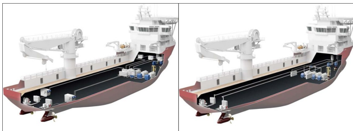
Σχήμα 8: Ένα πλοίο υποστήριξης πλατφόρμας με AC δίκτυο (αριστερά) και με Onboard DC Grid της ABB (δεξιά). [5]
