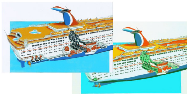
Σχήμα 2: Το κρουαζιερόπλοιο “M/S Elation” (κάτω δεξιά), εξοπλισμένο με προωστήρες Azipod, εξοικονομεί σημαντικό χώρο σε σχέση με το αδελφό πλοίο (πάνω αριστερά) με αξονική πρόωση. [1]
