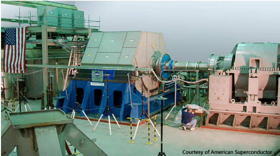
Σχήμα 27: Ο HTSSM 36.5MW της AMSC κατά τη διάρκεια των δοκιμών στο LBTS της Φιλαδέλφεια το 2007-2008. [32]
