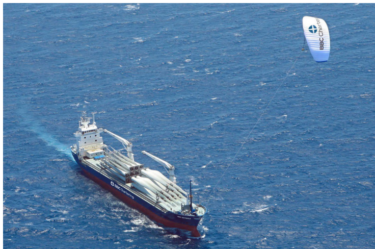
Σχήμα 34: Το φορτηγό πλοίο BBC SkySails με έλκυση από αλεξίπτωτο. [25]
