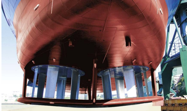
Σχήμα 6: Παράδειγμα εγκατάστασης προπέλας Voith Schneider [7].
