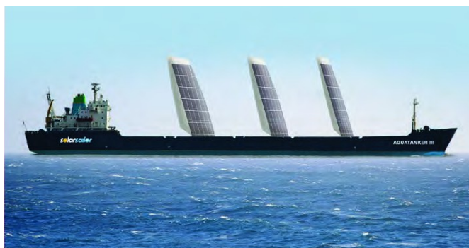
Σχήμα 38: Παράδειγμα συνδυασμού εκμετάλλευσης ηλιακής και αιολικής ενέργειας από την SolarSailor [1]. © SolarSailor 2013
