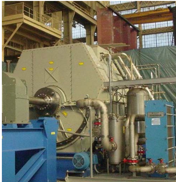
Σχήμα 25: Ο HTSSM 36.5MW της AMSC στις εγκαταστάσεις του US Navy.[29]
