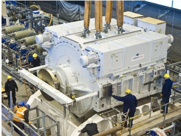
Σχήμα 16: Ο ένας από τους τέσσερις επαγωγικούς κινητήρες AIM των 20MW που έχουν τα αεροπλανοφόρα της κατηγορίας Queen Elizabeth του βρετανικού Βασιλικού Ναυτικού. [18]
