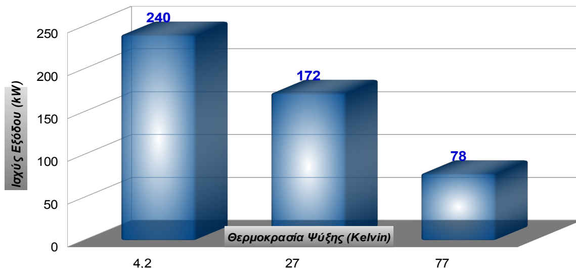
Σχήμα 29: Η ισχύς εξόδου της SDCHM του NSWC με HTS πηνία, που δοκιμάστηκε το 1998 στις ΗΠΑ, σε συνάρτηση με την θερμοκρασία ψύξης του υπεραγωγού. [31]
