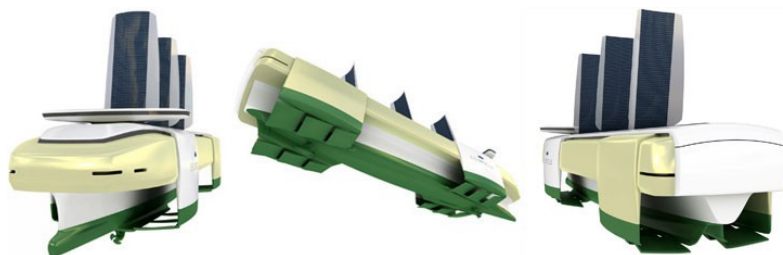
Σχήμα 39: Το σχέδιο του οχηματαγωγού “E/S Orcelle” με τα υποθαλάσσια πτερύγια για την μετατροπή κυματικής ενέργειας σε ηλεκτρική. [33]
